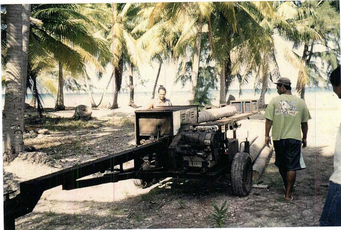
**Photos 26 et 27** - Sciage d'une bille de cocotier sur une scie mobile ERVE
