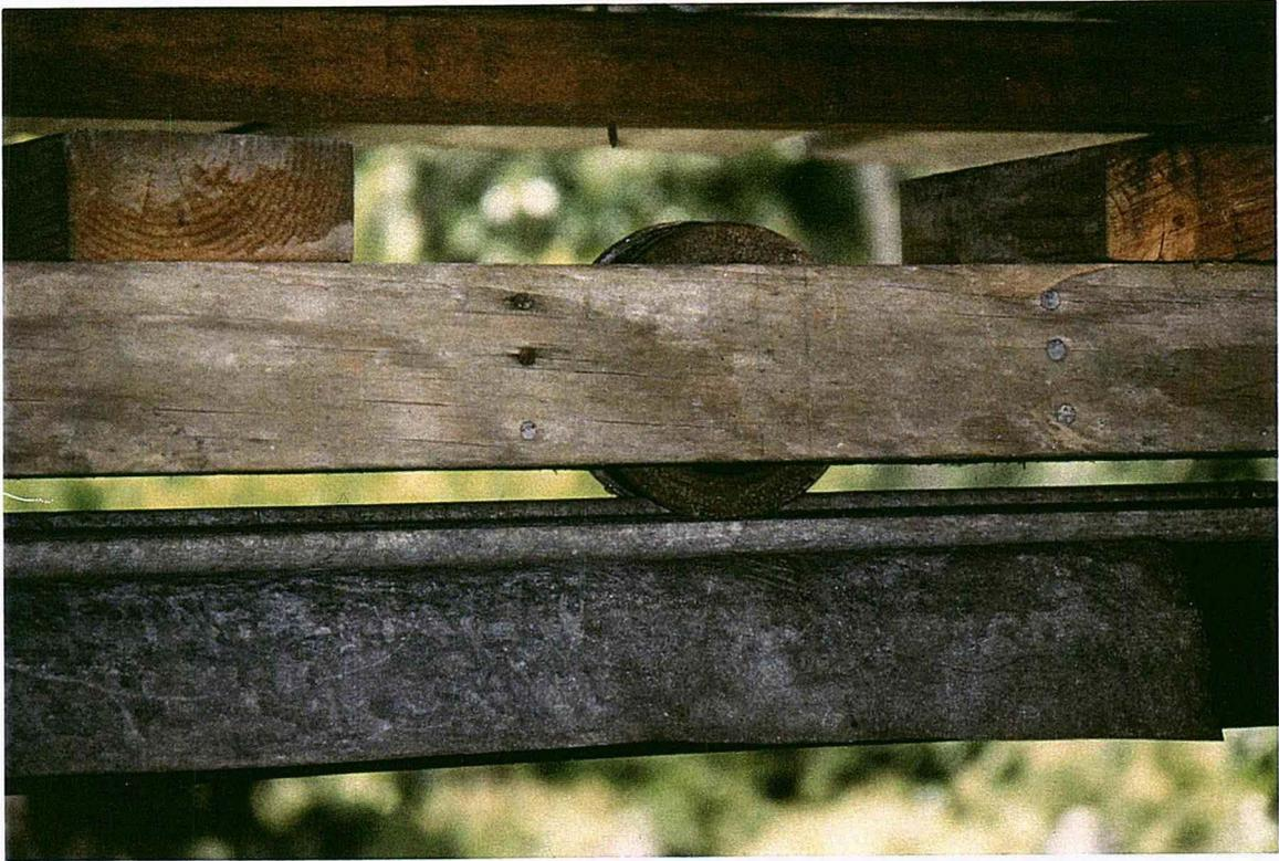
**Photos 20 et 21** - Séchoir FADIP, modèle vulgarisé (haut : détail du toit mobile ; bas : détail du fond en grillage sur lambourdes)
