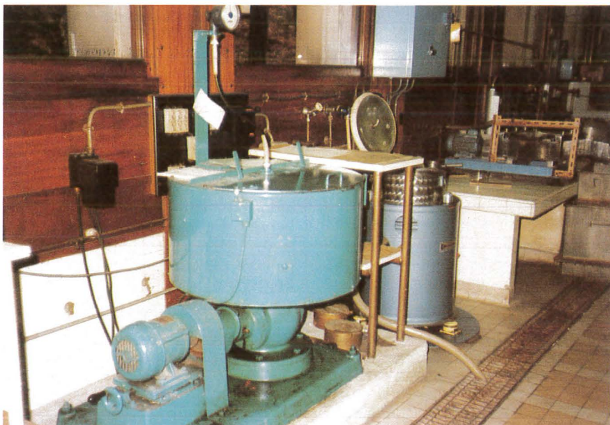
Raffineur Jokro. Division de cellulose et chimie du CTFT. Nogent-sur-Marne (France).
