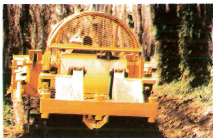
Sous-solage avant abattage d'une vieille palmeraie pour replantation.
