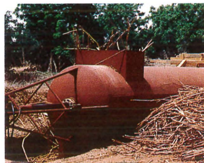
Transpaille, fermenteur en continu pour la production d'énergie et de compost.
