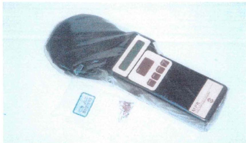
**Photo 19 bis :** Lecteur de marque magnétique employé pour la reconnaissance des géniteurs utilisés dans les croisements. Les marques magnétiques (4 à 5 mm de long) se trouvent dans le sac plastique. (partie inférieure du cliché)
