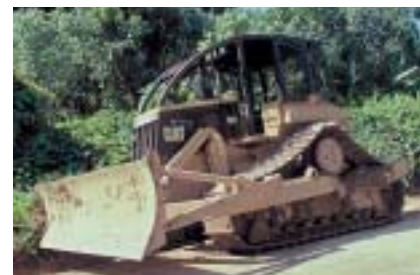
Débardeur à chenilles utilisé pour l'extraction dans une exploitation à faible impact.
