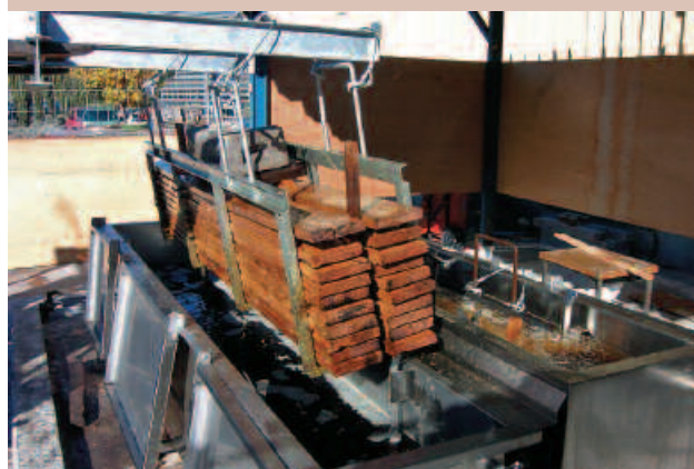
Bacs de trempé et de friture. Déchargement de la nacelle de transport du bac de trempé. Photo H. Baillères.
