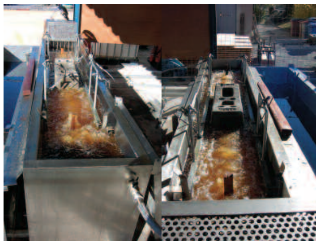
Lot de pièces de bardage en cours de traitement dans une huile végétale. Photo H. Baillères.
