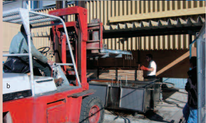
Disposition d'un lot de pièces de bardage dans la nacelle de transport destiné au bac de friture (a). Chargement dans le bac de friture (b). Photos H. Baillères.
