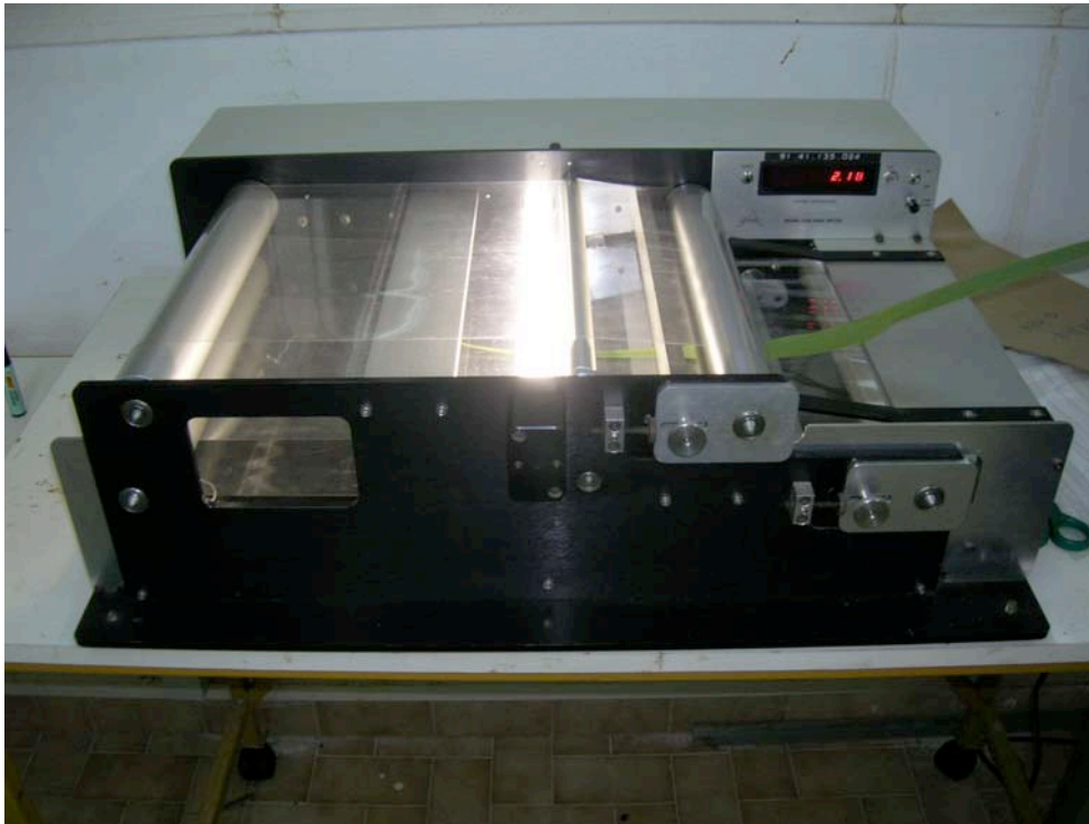
Photographie du planimètre de l'INRA à Duclos, utilisé pour établir les mesures de surface des feuilles de canne à sucre. (LICOR LI-3100C)
