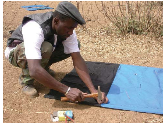
Figure 10. Fixation de l'écran sur les lattes à l'aide de pointes métalliques. (photo M. Desquesnes)
