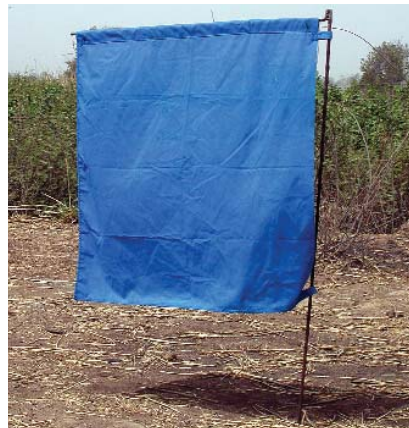
Figure 13. Ecran et sa potence métallique, utilisée en l'absence de supports végétaux naturels. (photo M. Desquesnes)
