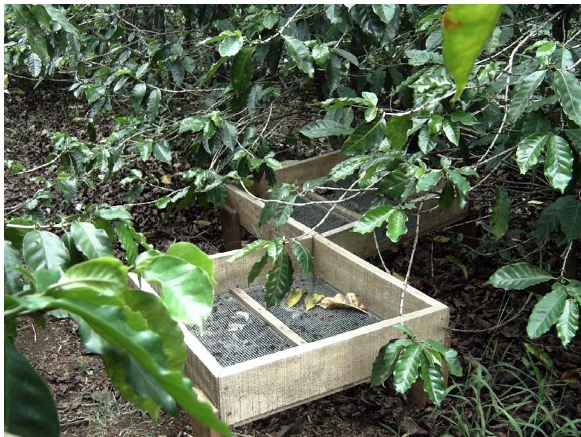
*Figure IV.1 : Dispositif de mesure de la chute de litière*
