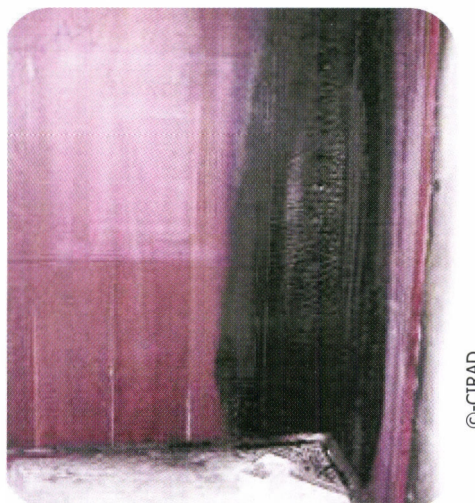
Essai de réaction au feu sur l'Amarante.
