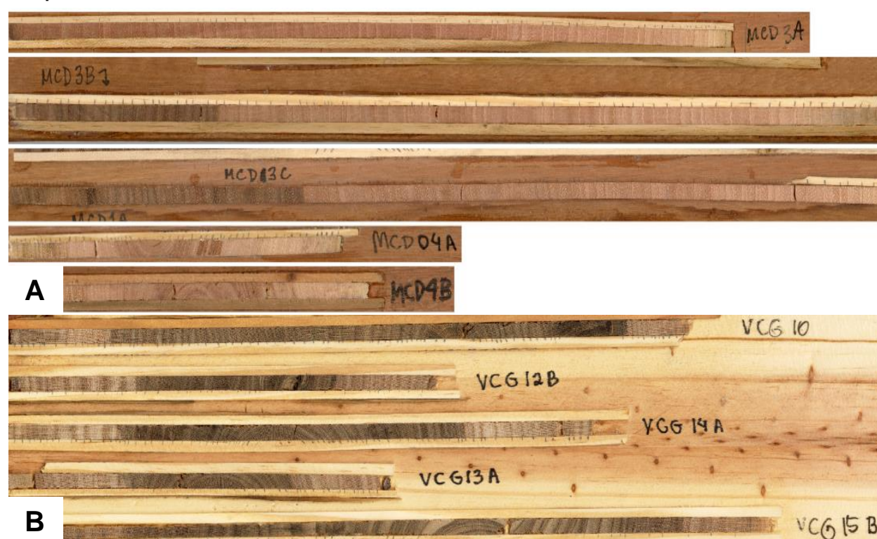
Fig. 1 Amostras não destrutivas de Copaifera duckei (A) e Cordia goeldiana (B) fixadas em suporte de madeira, com a seção transversal polida e acondicionadas, preparadas para as análises no espectrômetro NIR.
