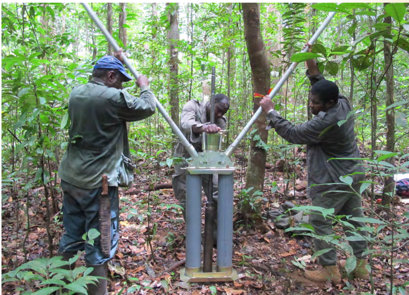
Prélèvement de sol en forêt guyanaise pour mesure les stocks de carbone du sol (crédit photo : V. Blanfort)
