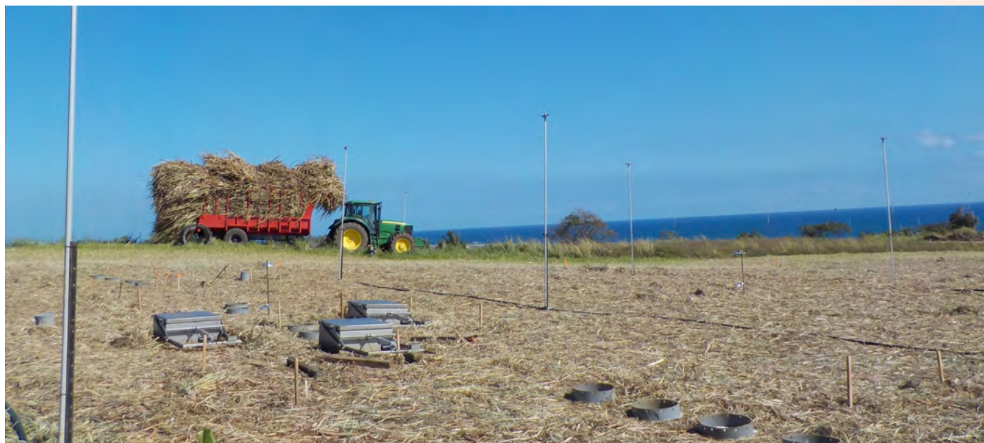
Chambres de mesure des gaz à effet de serre sur le dispositif SOERE PRO à La Réunion (crédit photo : J. Demenois)
