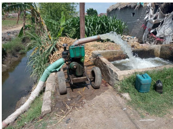
Figure 15 : Pompage de l'eau du Nil dans un canal à l'aide d'une pompe Diesel, Khamara, Égypte
