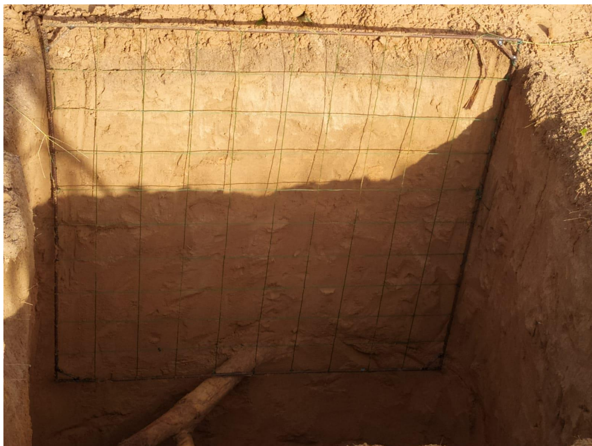
Fig. II-4 Photographie d'un profil de sol sur le site Faidherbia-Flux jusque 150 cm de profondeur. Chaque carré de la grille fait 10 cm 2 .
