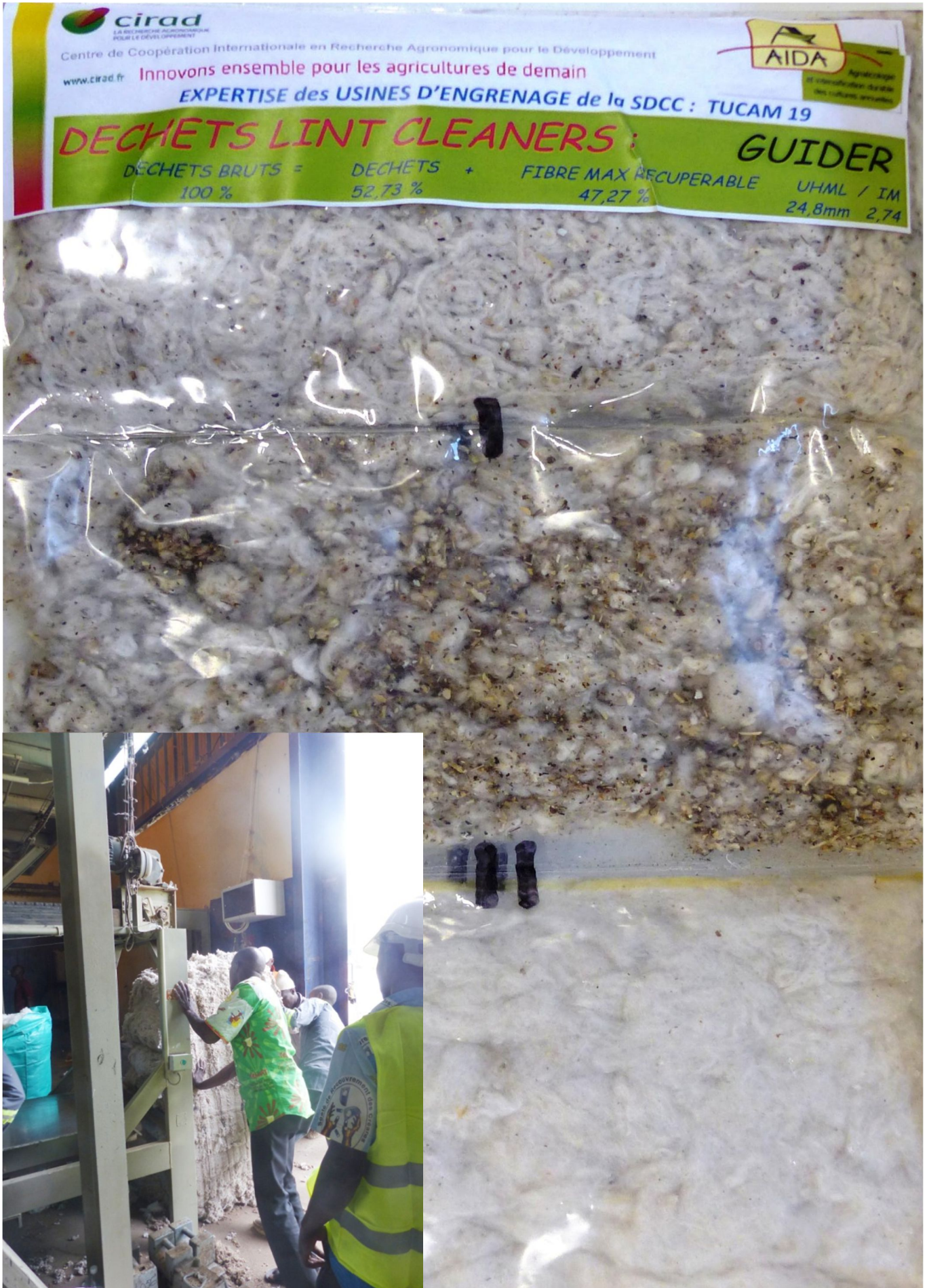
Pesée d'une balle de déchets LC en fin d'essai et échantillon de déchet brut, déchet résiduel et fibre récupérable.
