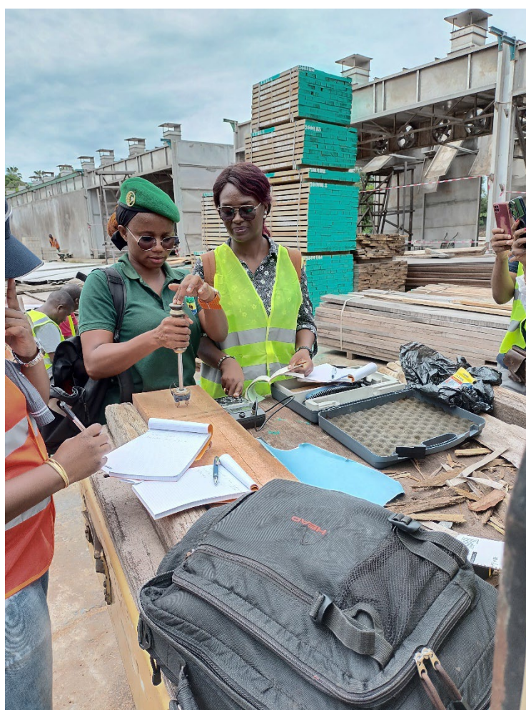
Exercice de mesure du taux d'humidité du bois à l'aide d'un humidimètre à pointes
