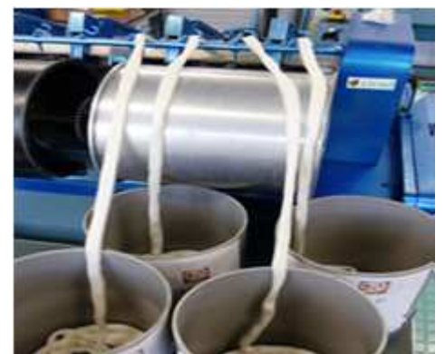
Entrée des quatre rubans, un par broche. Les rubans sont amorcés pour aller vers les 4 bobines sous forme de fil après torsion.
