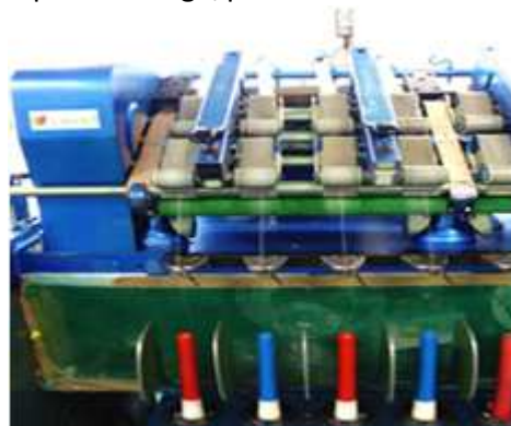
Entrée des quatre rubans, un par broche. Les rubans sont amorcés pour aller vers les 4 bobines sous forme de fil après torsion.
