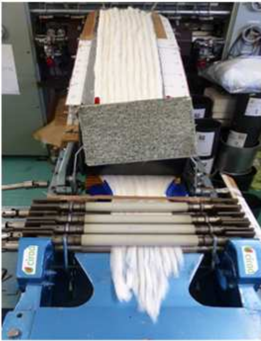
L'amorçage des 10 rubans avant la trompette
