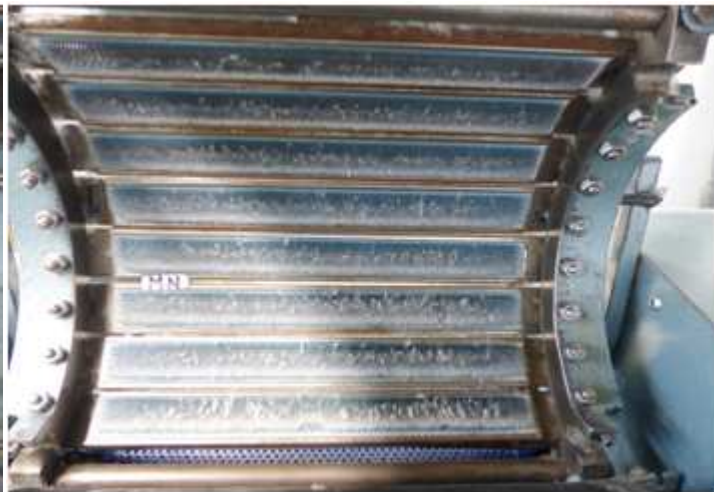
Secteurs cardants des cotons M N : Z2347 Manuelle 20s : 1,16g
