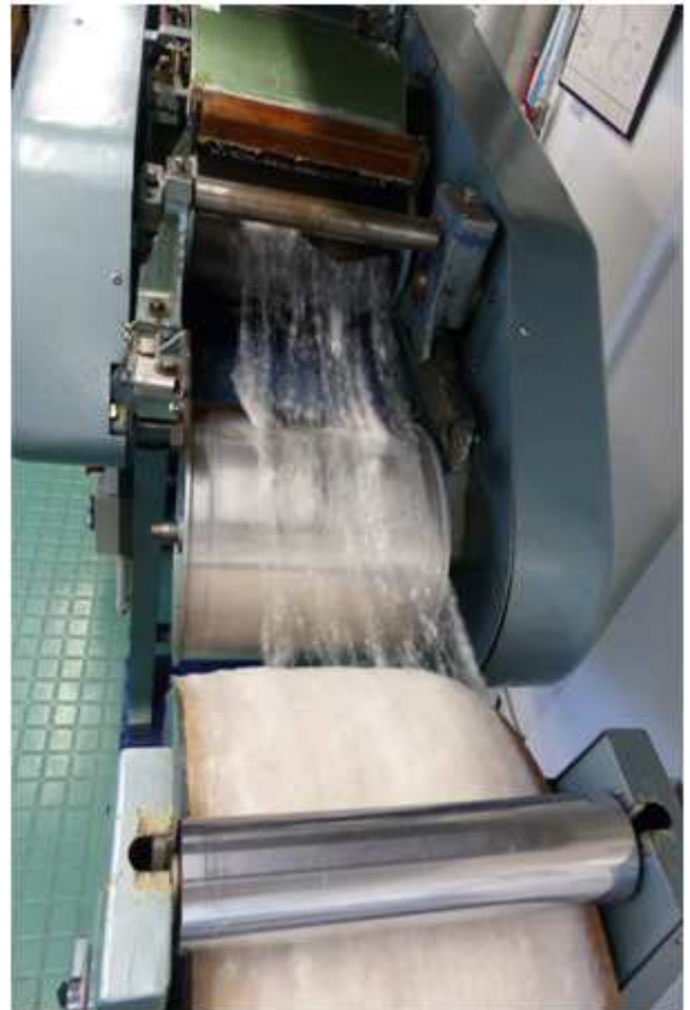
Fig 2 : Le voile en sortie de carde 1 er passage
