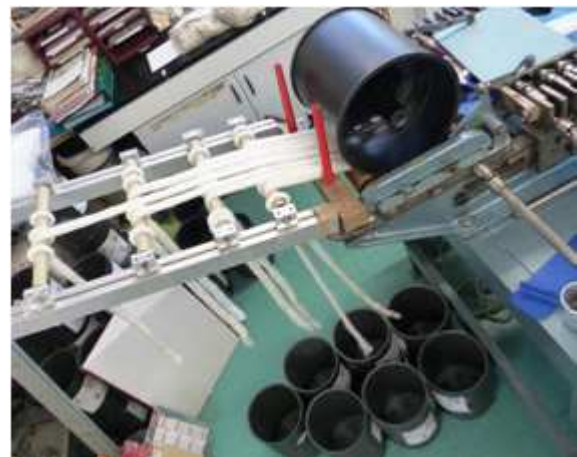
En fin d'étirage, les pots sont vides et les 7 rubans vont se terminer
