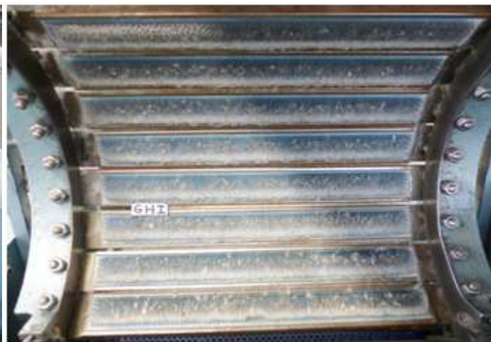
Secteurs cardants des cotons G H I : Q302 Stripper 20s : 1,5g
