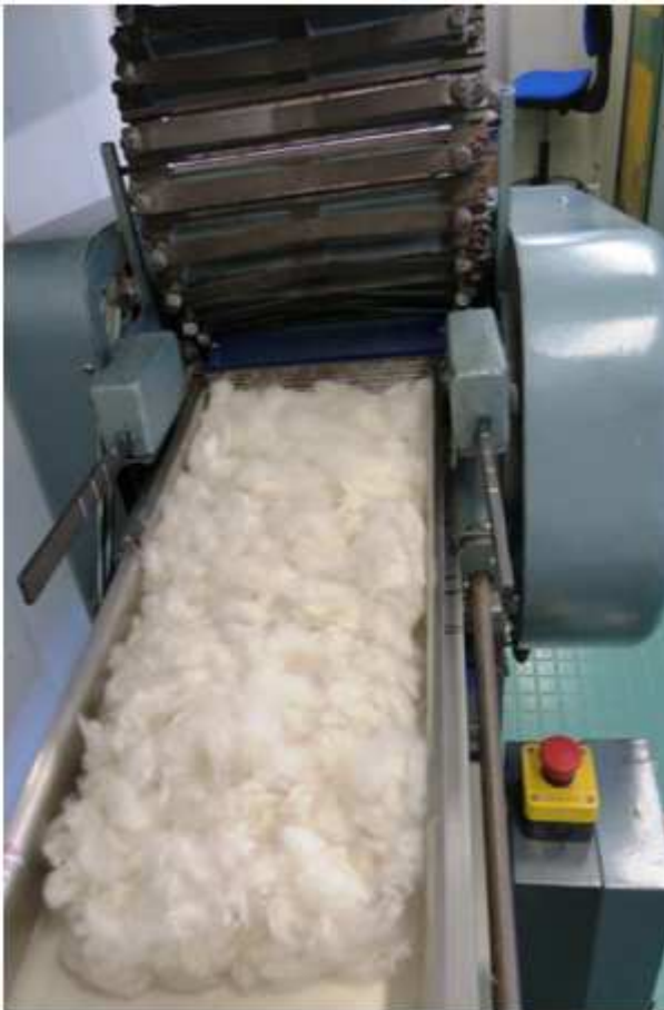
Fig 1 : La nappe d'entrée carde
