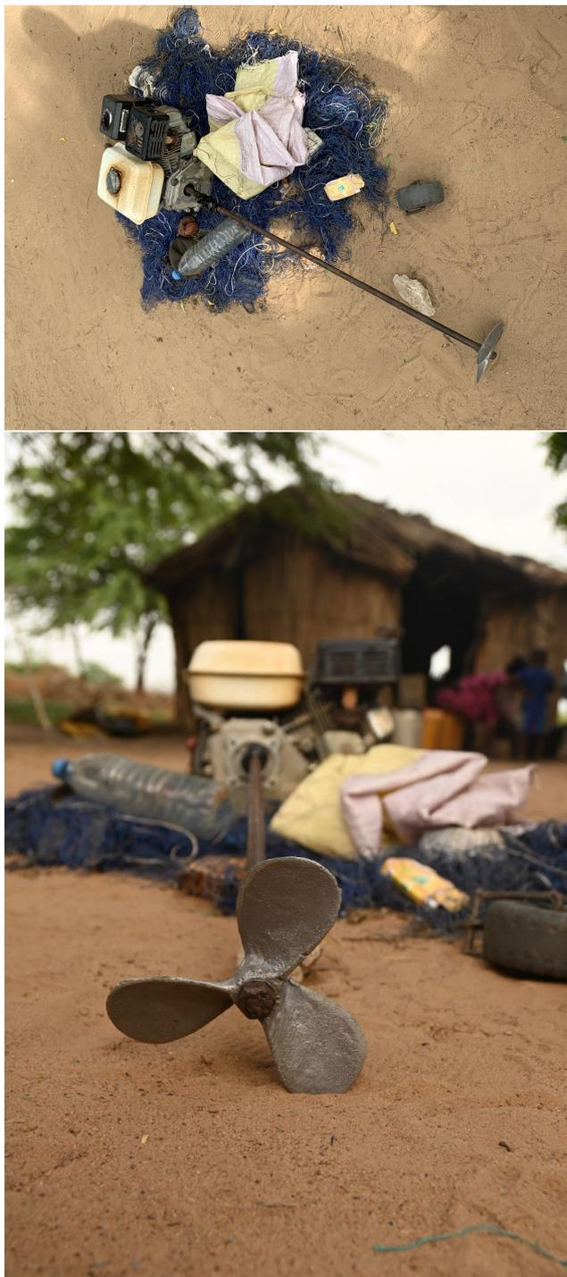
FIGURE 2.8 – Moteur de pirogue bricolé a partir d'une motopompe
