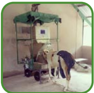
Green Feed- dispositif de mesure d'émissions de méthane entérique
