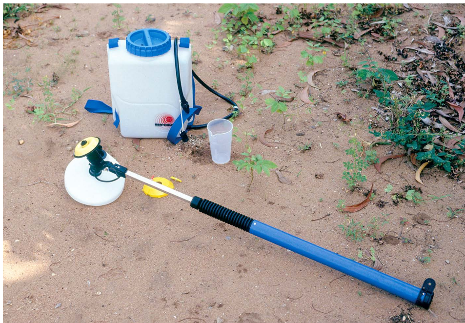
Figure 93. Appareil de pulvérisation à disque rotatif et réservoir dorsal pour appliquer à « très bas volume » (10 l/ha) (Bénin, Sikki-Gourou, septembre 1994)
