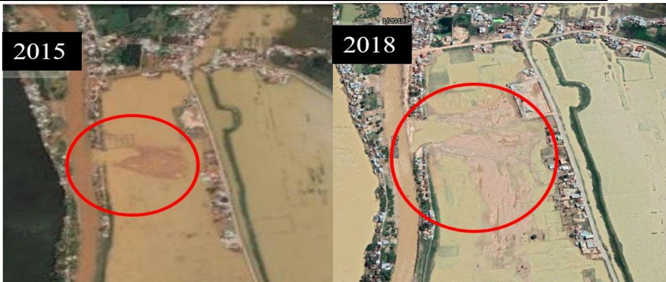
Photo 1 : Inondations par rupture de digues en 2015 et en 2018 (image : google Earth)
