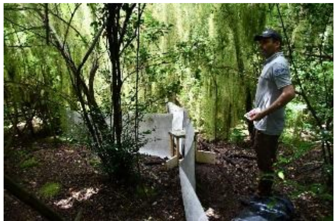
Figure 19. Piège photographique HALT 2 et ses barrières de dérivation installées sur l'îlet du Galion (photo : Alice Armand OFB)
