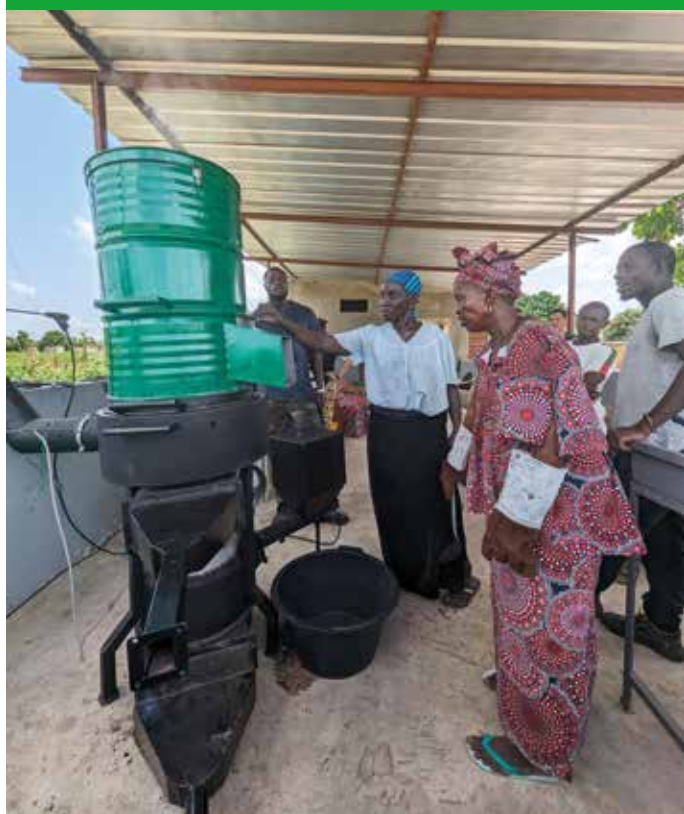
Formation d'utilisatrices PME UTAS-Prototype d'étuveuse à combustion de coques d'anacarde pour étuvage des noix © BioStar - Th. Ferré
