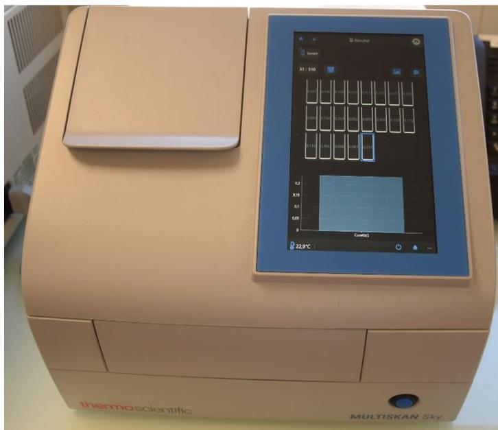
Figure 6 : spectrophotomètre utilisé pour la mesure de l'absorbance des échantillons.
