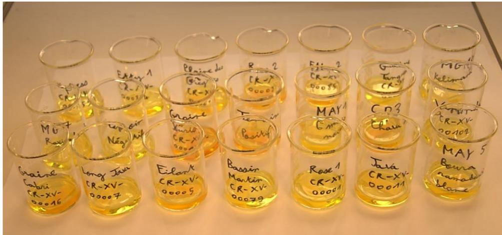
Figure 9 : préparation des solutions pour l'utilisation du spectrophotomètre (élution dans l'eau de la couleur des papiers picrates).
