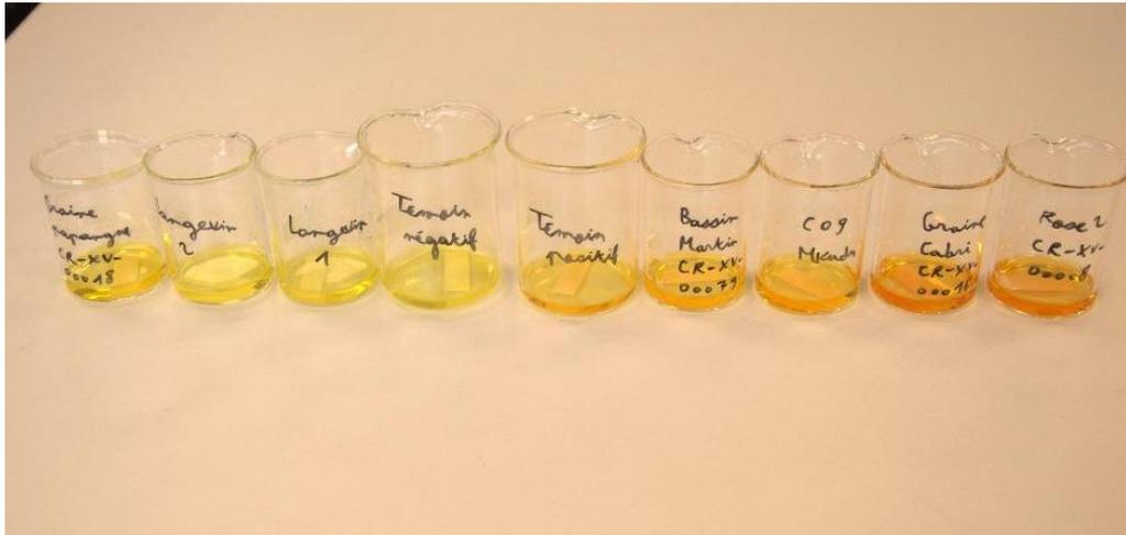
Figure 11 : préparation des solutions pour l'utilisation du spectrophotomètre (élution de la couleur des papiers picrates dans l'eau).
