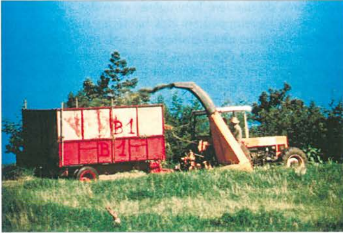
Ensilage de dactyle et de kikuyu avec une récolteuse hacheuse chargeuse à fléaux dans les Hauts de l'Ouest (photo J.M. Paillat).
