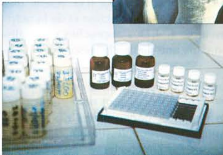
Dosage de la progestérone dans le lait (photo E. Tillard).
