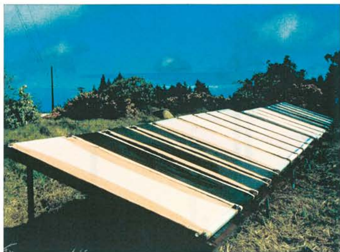
Exposition des films étirables sur des cadres en bois inclinés à 21° et orientés vers le nord, à la Plaine des Cafres, à 1 500 mètres d'altitude (photo J.M. Paillat).
