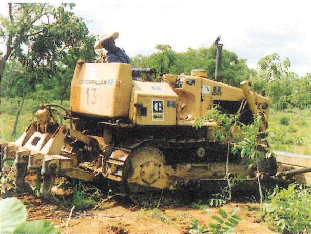
Photo 3 : Travail de préparation d'une parcelle au D4 et ripper 3 dents (photo D. DULIEU).
