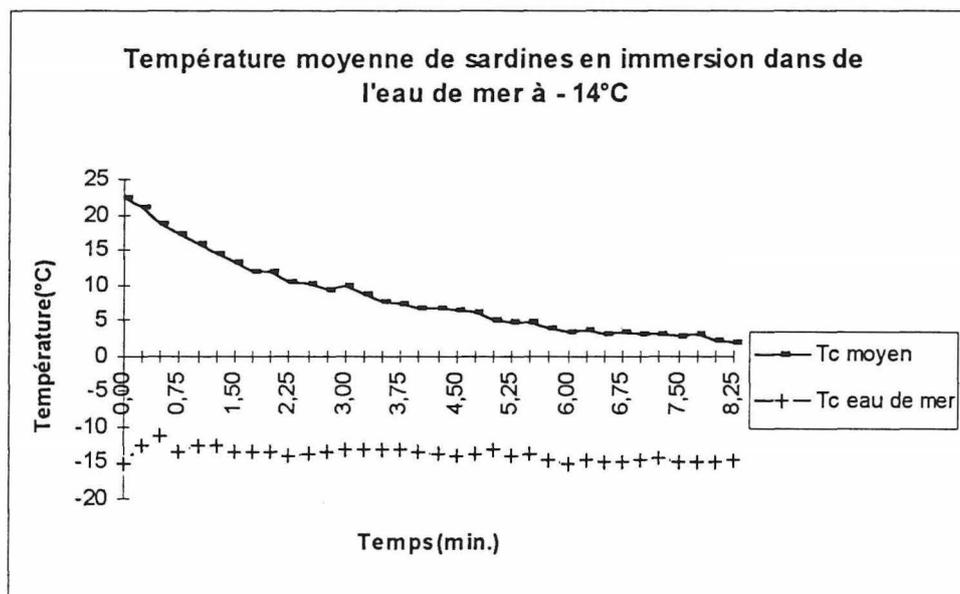
Figure 15 : Suivi thermique de sardines en refroidissement par immersion dans de l'eau de mer à -14°C.
