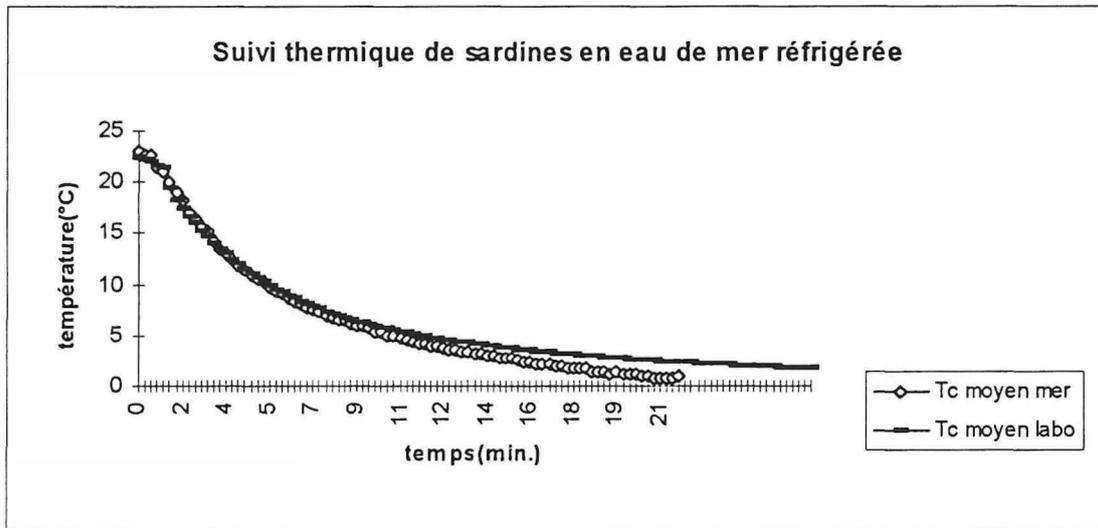
Figure 13 : Température moyenne de sardines en eau de mer réfrigérée à 0°C.
