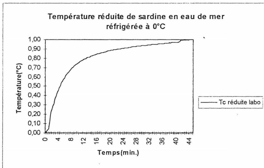
Figure 9 : Température réduite de sardines en eau de mer réfrigérée à 0°C.
