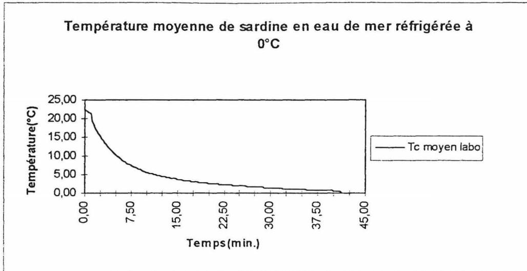
Figure 8 : Suivi thermique de sardines en eau de mer réfrigérée à 0°C.
