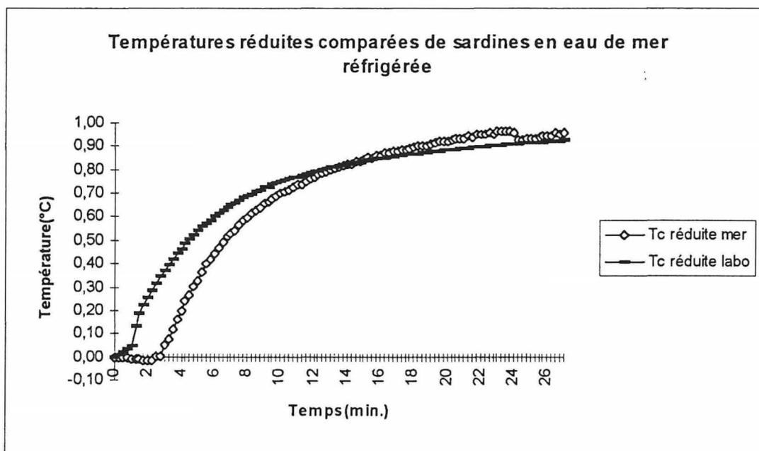
Figure 14 : Température comparée réduite de sardines en eau de mer réfrigérée à 0°C.
