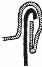
Fig. 4 : Compression trop faible
