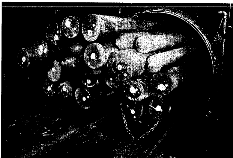
Sortie des poteaux après opération d'imprégnation aux sels C.C.A.
