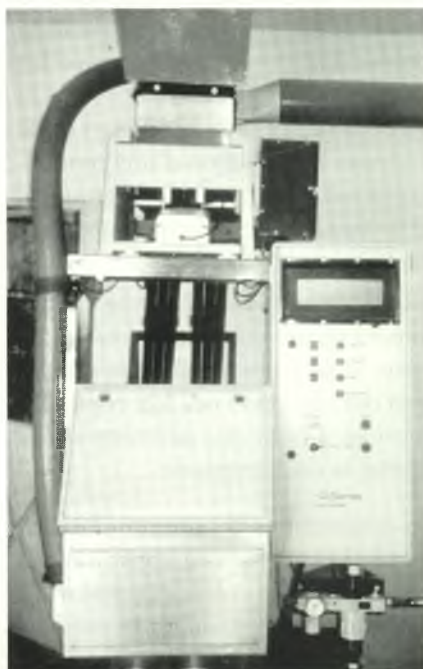
Machine de tri électrocolorimétrique des arachides à Kaolack, Sénégal. (P. Dimanche)
