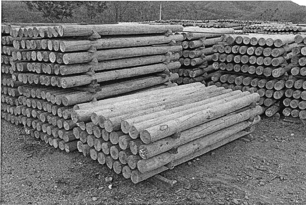
Stockage de poteaux standards de diamètre 16 cm réalisés dans des bois d'éclaircie de pinus caribaea âgés de 12 ans et élagués à 6 ans. ( Production Nouvelle Calédonie 2002 )
