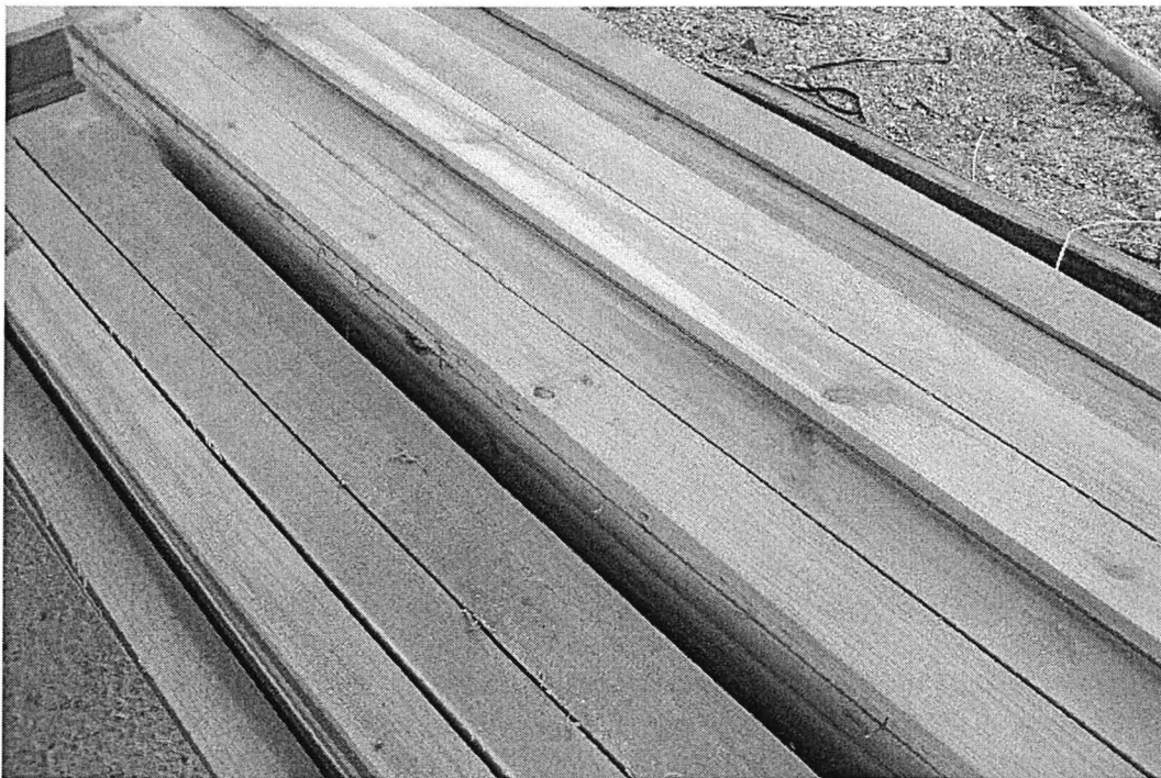
Sciages réalisés sur des arbres âgés de 25 ans issus de parcelles dans lesquelles deux élagages ont été réalisés à 3 m puis à 6 m. Les nœuds sont sains et indiquent
