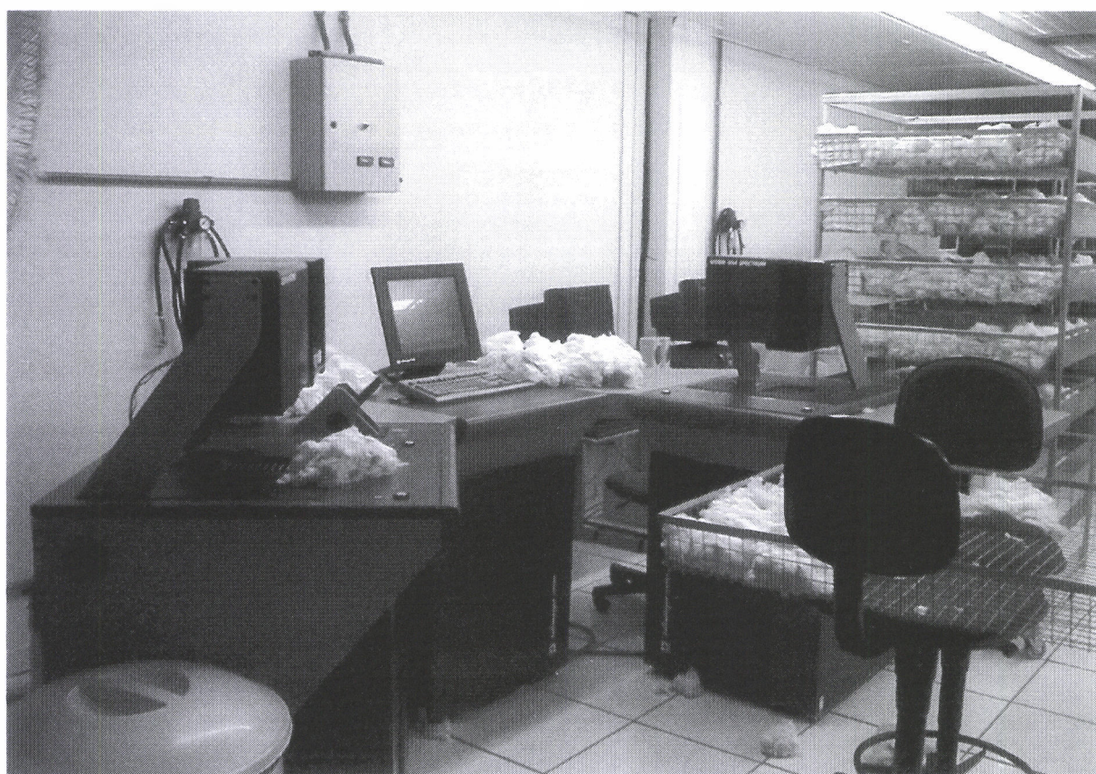
Figure 13. CMI et afficheurs de conditionnement (au mur) dans le laboratoire de Cooperfibra (cliché B. Bachelier).
