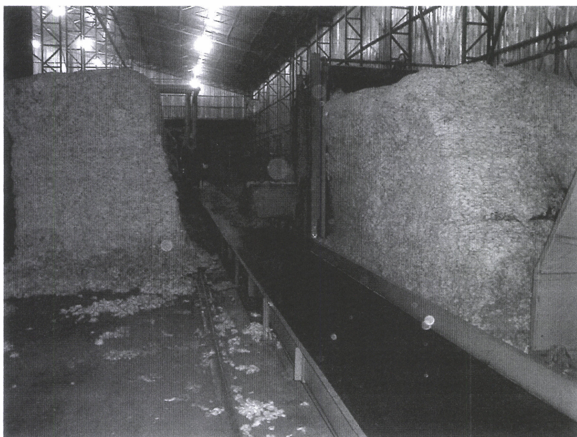
Figure 21. Dispositif « piranha » d'alimentation d'une usine d'égrenage en coton-graine (cliché B. Bachelier).
