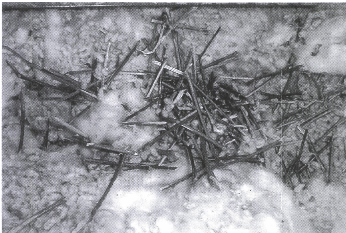
Figure 14. Fragments de tiges de cotonnier dans une poitrinière d'égreneuse (cliché B. Bachelier).
