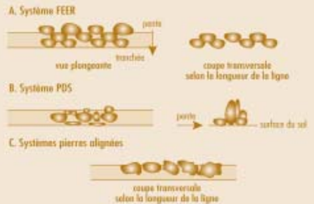
Les trois systèmes de diguettes en pierres
