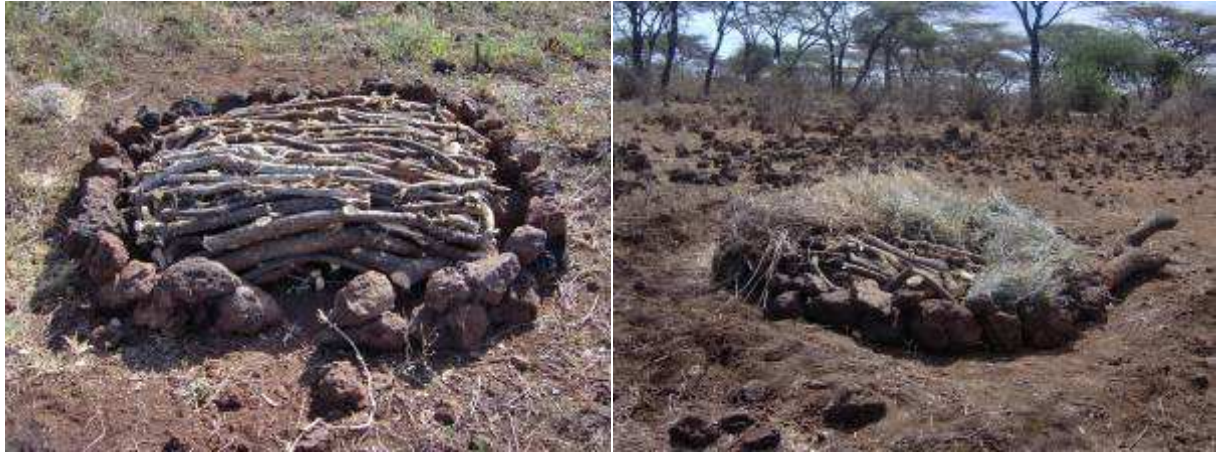
Figure 12: Etapes de préparation des meules : 1. Mise en pile des troncs, 2. Disposition de la barrière de pierres, 3. Recouvrement par une couche d'herbe avant la couche de sol
