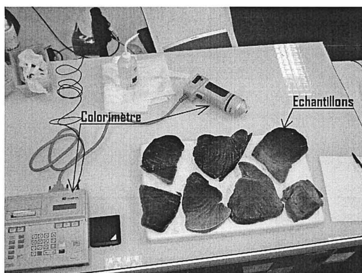
Figure 6 : Photo du dispositif pour la mesure de couleur
