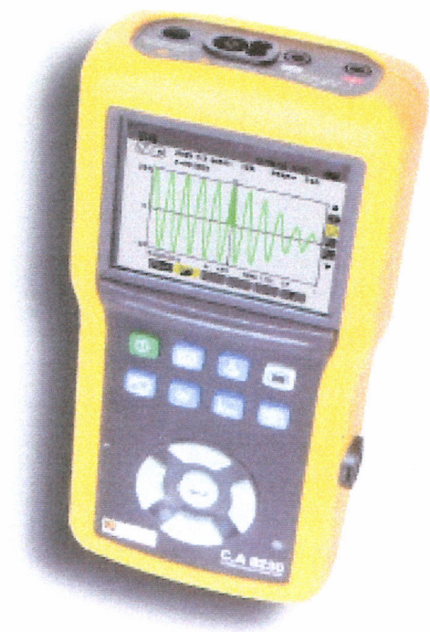
Photos 1 & 2 : Analyseur de réseaux électriques et branchement de l'appareil sur le site
