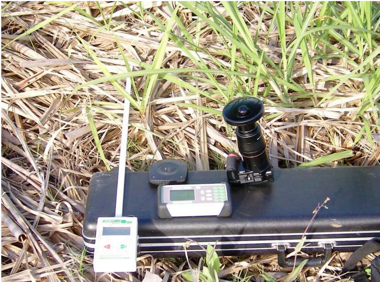
*Ceptomètre, Fkuorimètre, Fish eye. Cliché D. Pouzet*
