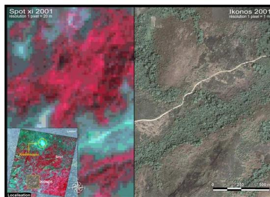
Figure 24. Différence de perception du terrain avec deux images juxtaposées : Spot4 XS à 20m de résolution et Ikonos à 1m de résolution (source : Imbernon, Cirad).
