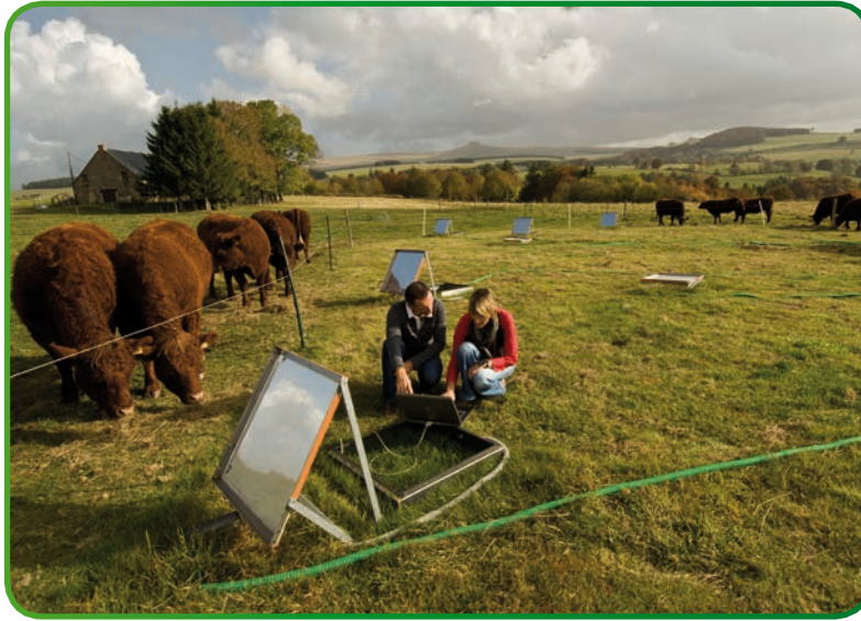
Figure 6. Chambre automatique de mesure de N_2O . (Photo : H. Raguét, Look at Sciences)
