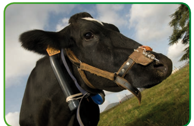
Figure 9. Collecte des gaz érucés en utilisant un traceur ( SF_6 ). (Photo : H. Raguét, Look at Sciences)
