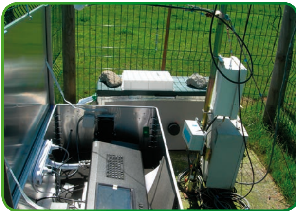
Figure 8. Analyseur permettant de mesurer le méthane par la méthode d'eddy corrélation.
