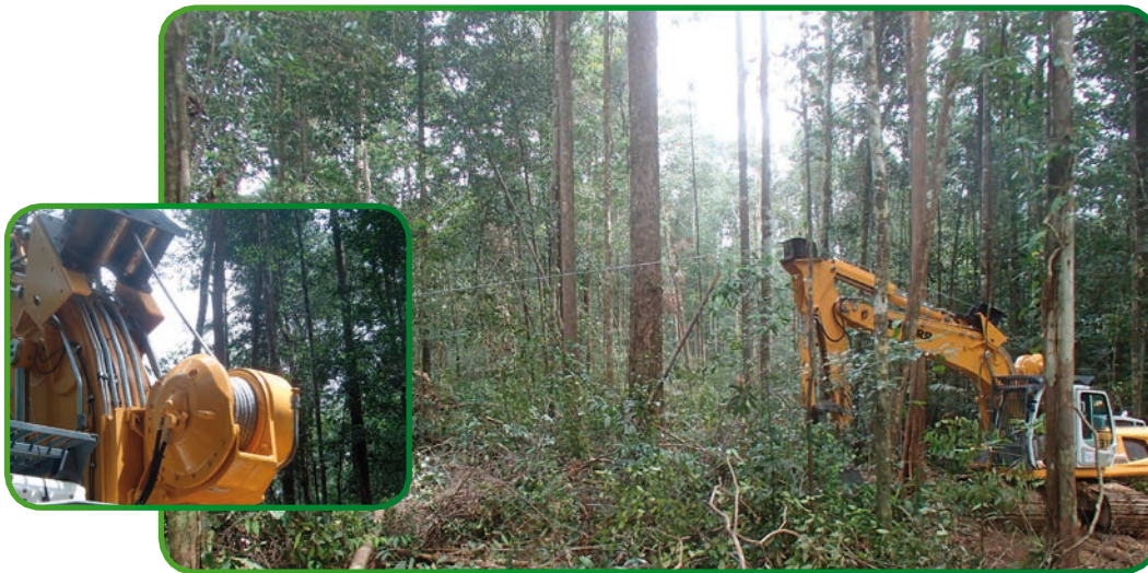
Figure 6. Débusqueuse à treuil avec câble synthétique et grappin à bois.
