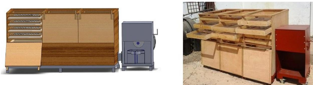
Figure 33. Séchoir CSec-T fabriqué à Dakar (© ESP)
