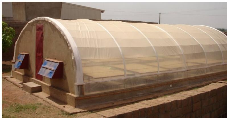
Figure 37. Séchoir « serre solaire » CSec-S installé par le Cirad au Mali en 2006 (© J-F Cruz, Cirad)
