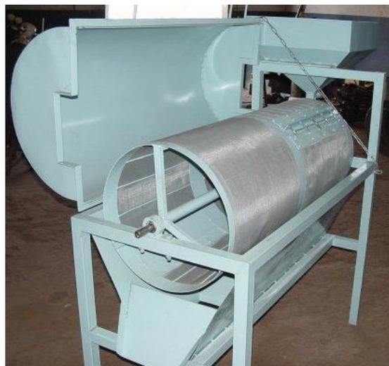
Figure 20: Crible rotatif (© M. Rivier, Cirad)
