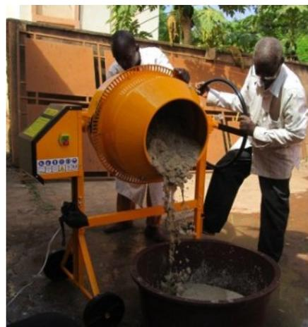
Figure 22. Essai du laveur rotatif au Mali (© IER)
