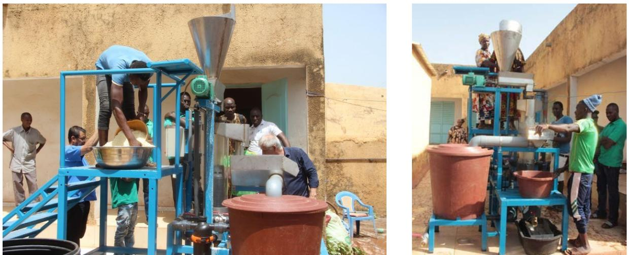
Figure 30. Installation du dessableur hydrolift à Kédougou au Sénégal Oriental (© V. Bancal, Cirad)
