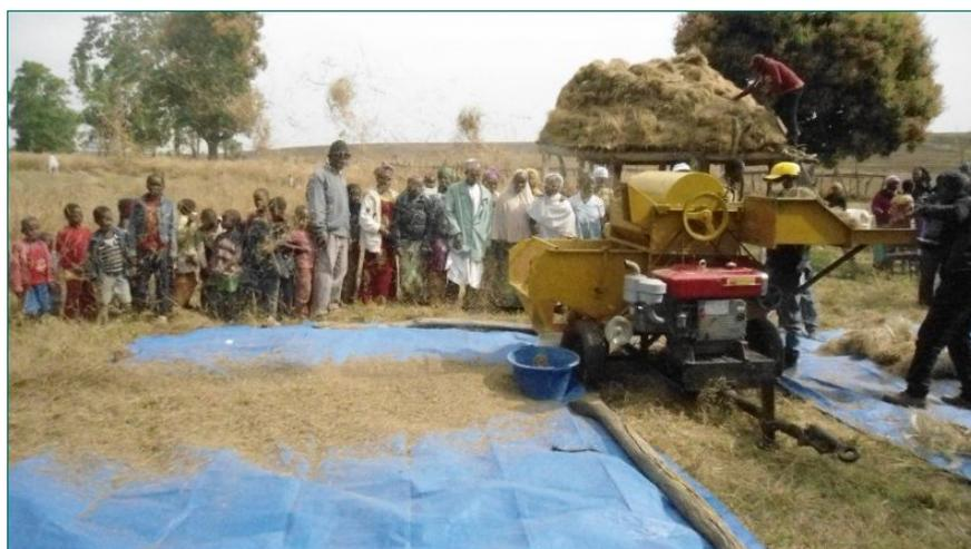
Figure 14. Essai/démonstration de battage mécanique du fonio à Donghel Sigon (© S. Camara, IRAG)
