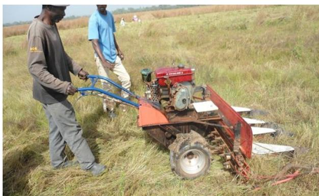
Figure12. Test de fauchage mécanisé en milieu paysan (© IRAG)
