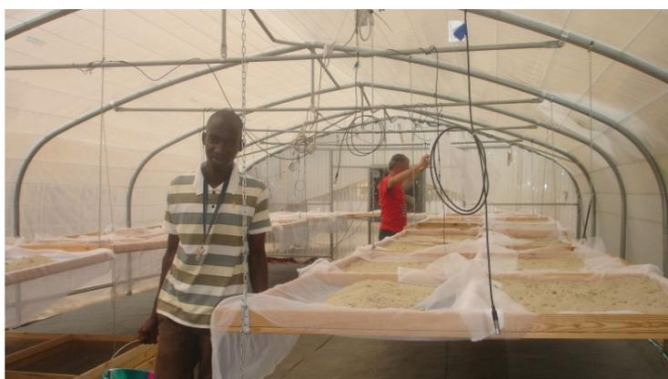
Figure 43. Essai de séchage du fonio en serre solaire à Dakar (© J-F Cruz, Cirad)
