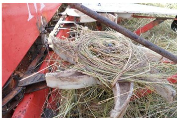
Figure13. Enroulement des pailles (© IRAG).
