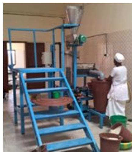
Figure 28. Le dessableur hydrolift 02 à Danaya Céréales à Bamako (© P. Thauhay, Cirad)
