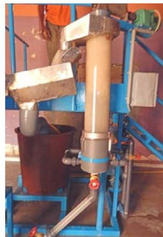
Figure 27. Le dessableur hydrolift et la colonne de dessablage à Ucodal à Bamako (© P. Thauhay, Cirad)
