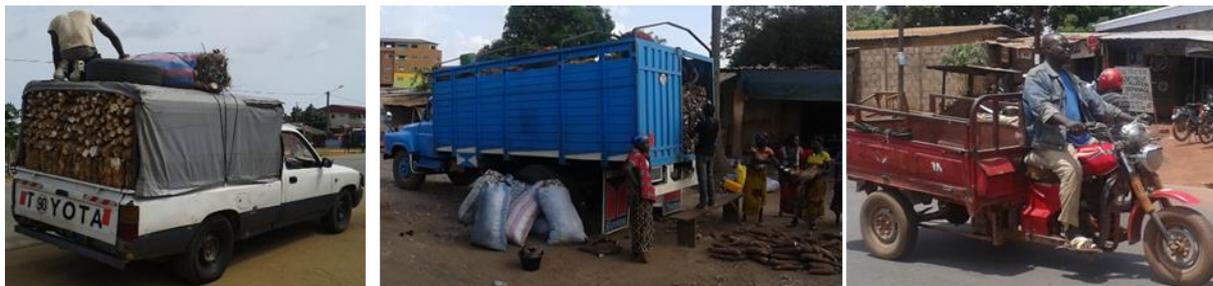
Photo 1 : bâchée (2 à 2,12 t) Photo 2 : semi-remorque (10 à 15 t) Photo 3 : mototaxi (800kg)
