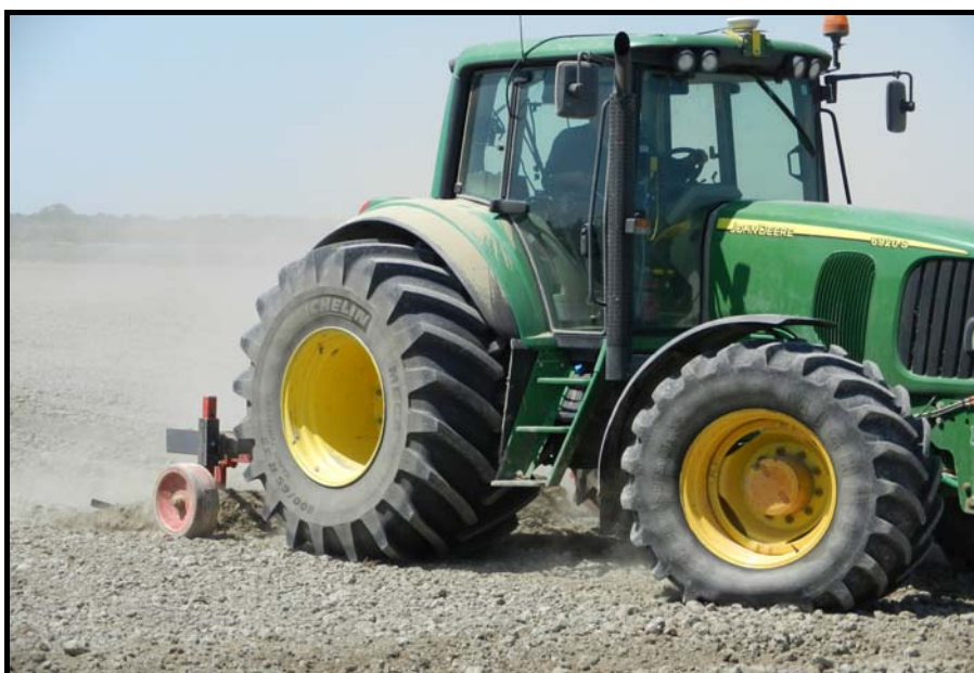
Photo 4: Traceur avec roue de jauge
