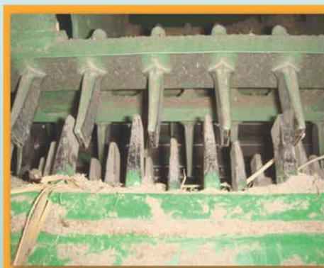
Batteur lâche : défauts de battage
