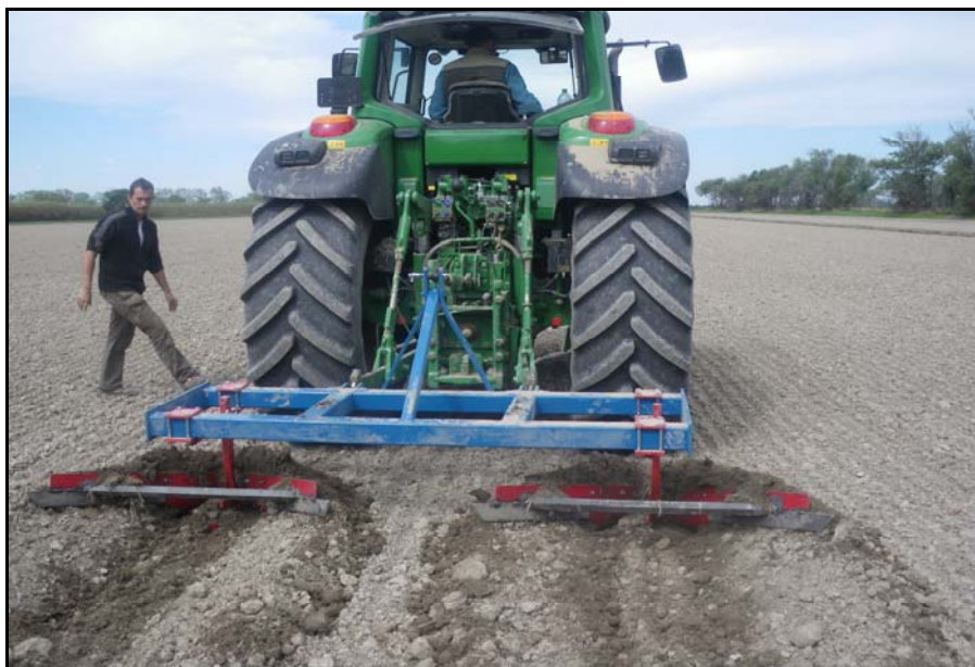
Photo3: Traceur sans roue de jauge laissant un bourrelet
