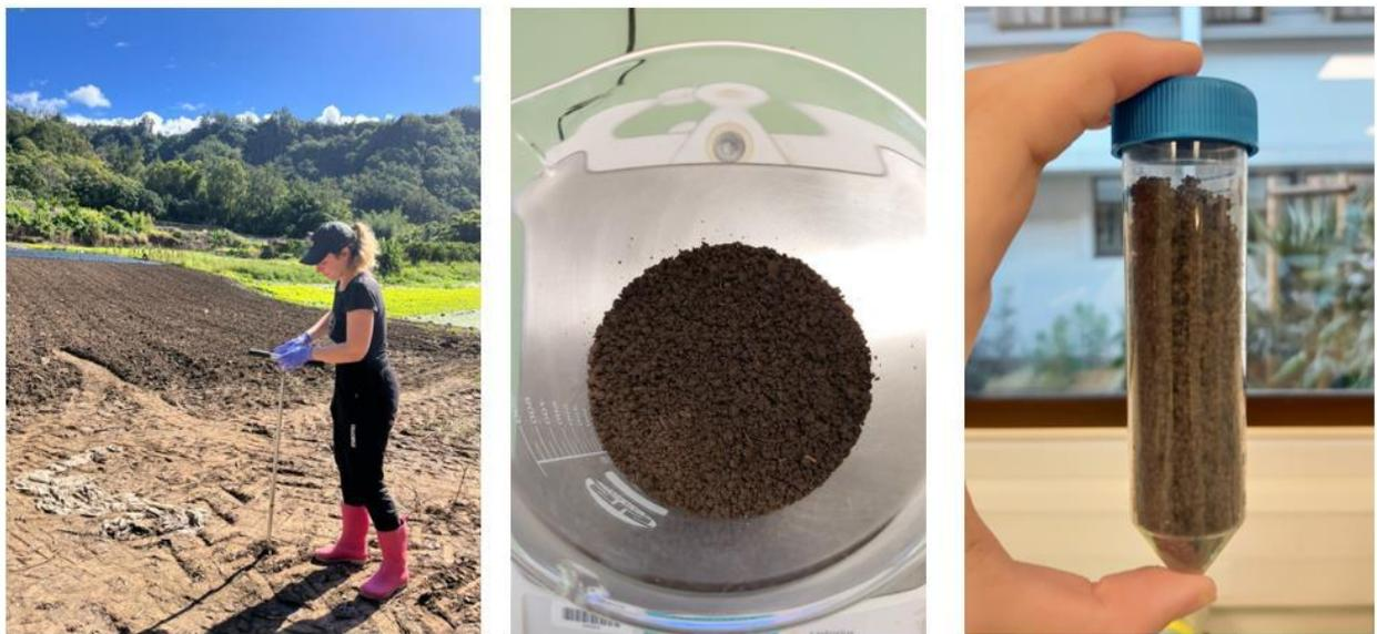
Figure 13 : Photographies des différentes étapes, de gauche à droite, du prélèvement des sols à la tarière, du sol tamisé à 4 mm et de l'aliquote en tube Falcon de 50 mL.
