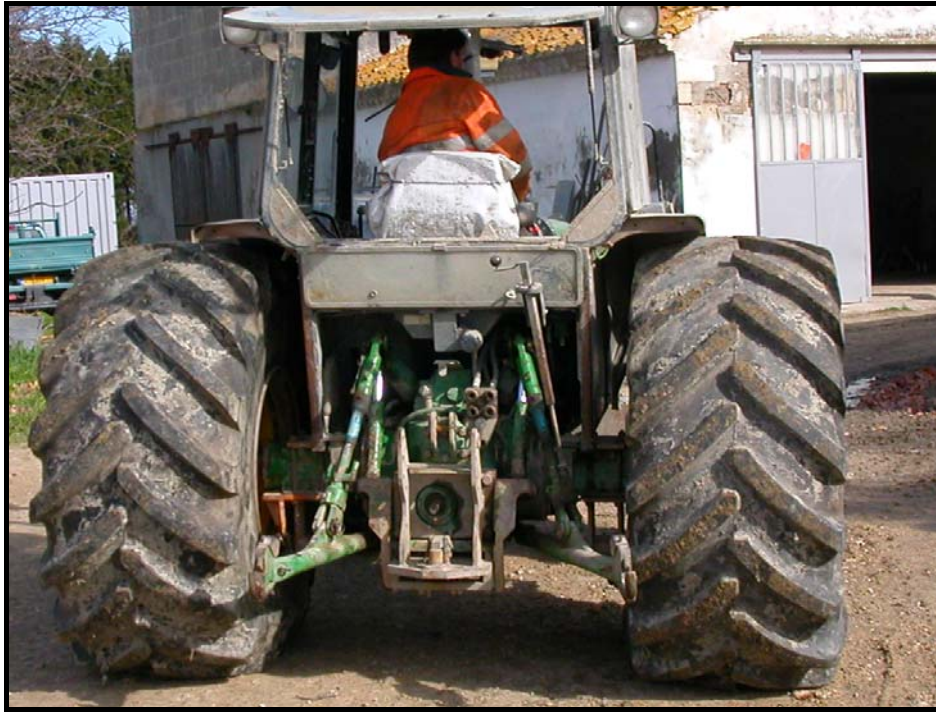
Adaptation de pneus 800/65 R 32 de moissonneuse batteuse sur un tracteur de 80 cv
