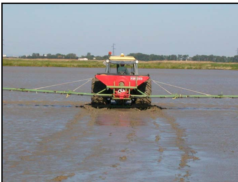
Semis de riz pré-germé sur pneus basse pression avec un semoir pneumatique
