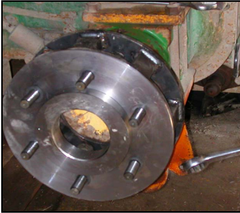
Construction d'élargisseur de voie
