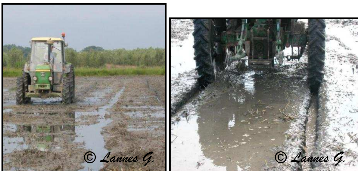
Figure 34 : Essais de portance en pneumatiques étroits gonflés à faible pression
