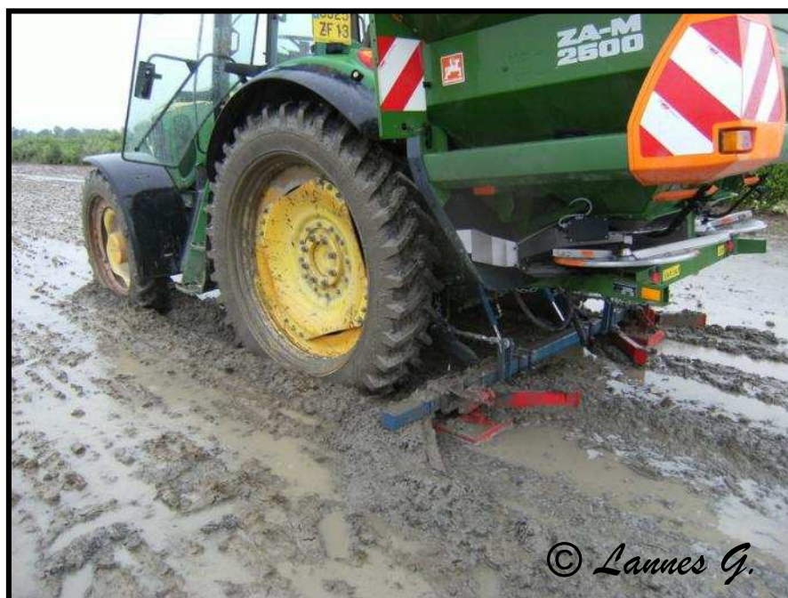
Figure 35 : Seconde génération d'efface-traces monté sous le relevage arrière du tracteur
