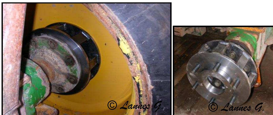
Figure 33 : Elargisseurs de voie fabriqués pour permettre la fixation des pneumatiques
