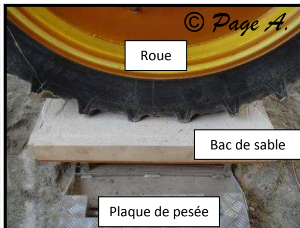
Figure 40 : Mise en place du bac de sable entre la roue et la plaque de pesée
