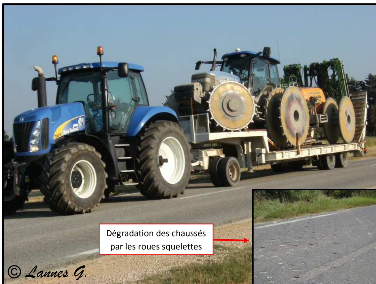
Figure 17 : Tracteur et porte-engin utilisé pour le déplacement des tracteurs en roues squelettes
