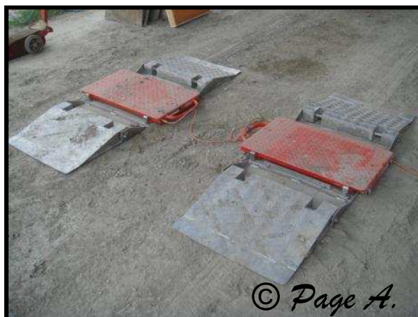
Figure 39 : Mise en place des plaques de pesée
