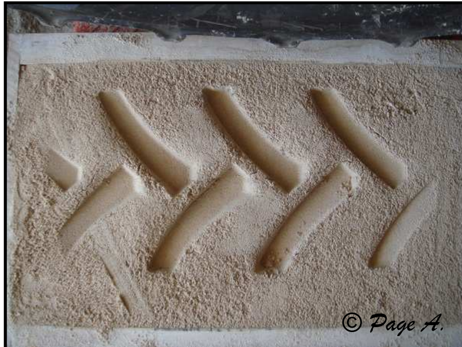
Figure 43 : Empreinte obtenue à 0,8bar de pression et 1100kg de charge (Kléber 300/95 R52)
