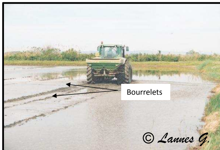
Figure 31 : Illustration du bourrelet laissé par le passage des pneumatiques
