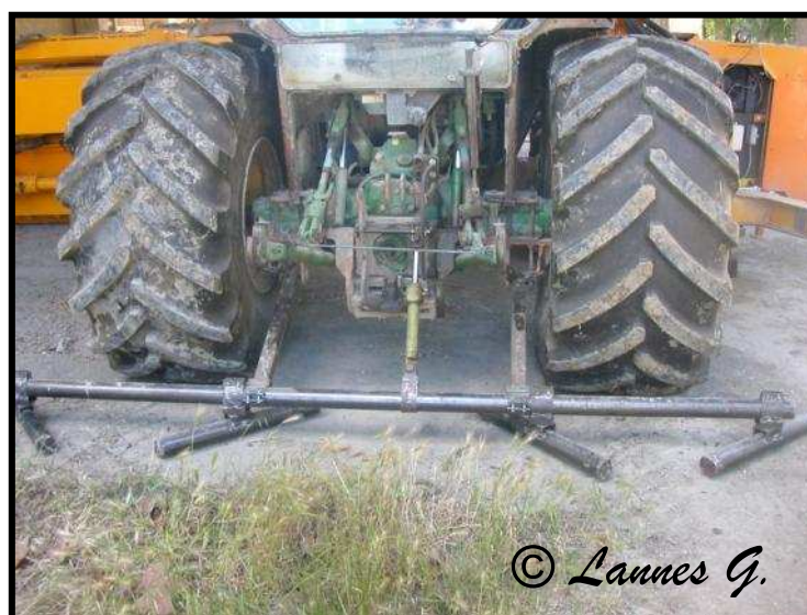
Figure 32 : Efface-traces rudimentaire placé sous le relevage arrière du tracteur
