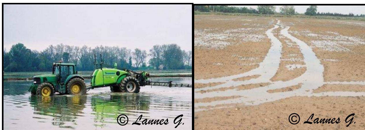
Figure 29 : Traces laissées par les pneumatiques grandes largeurs lors des essais de portance
