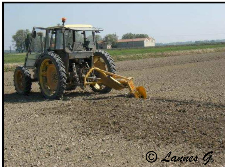
Figure 37 : Rigoleuse utilisée pour créer les entrées et sorties d'eau
