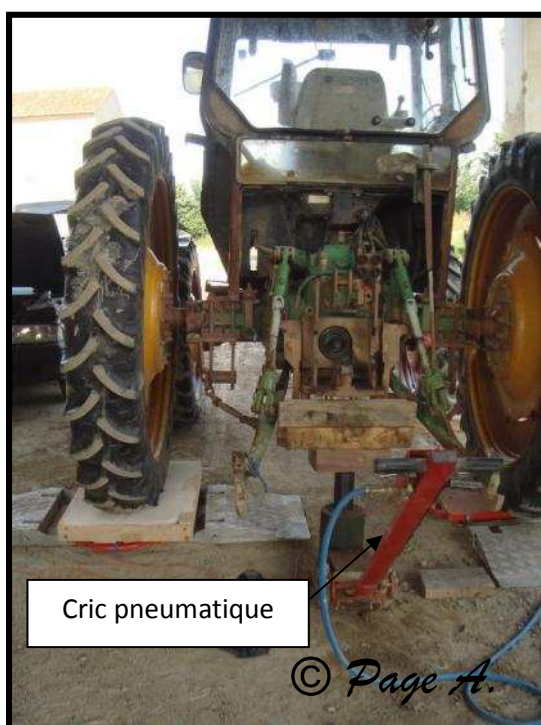
Figure 41 : Contrôle du poids via le cric pneumatique
