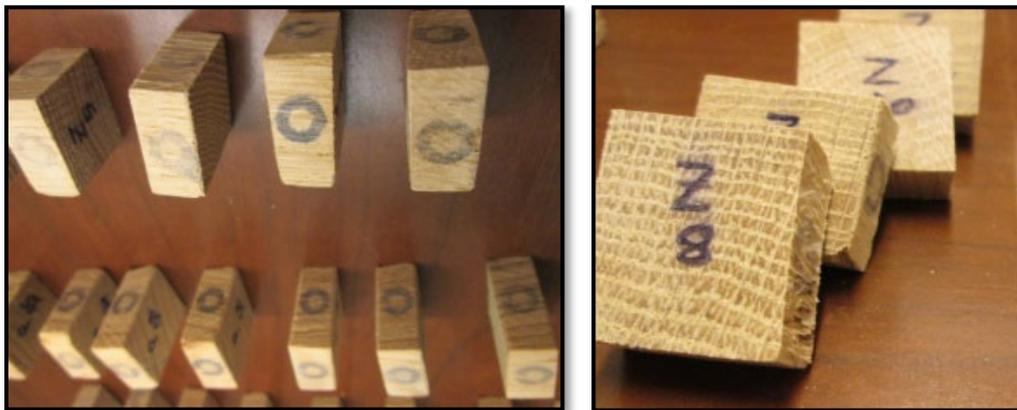
Figure 3.1.7 : Éprouvettes de retraits linéaires et PSF.
