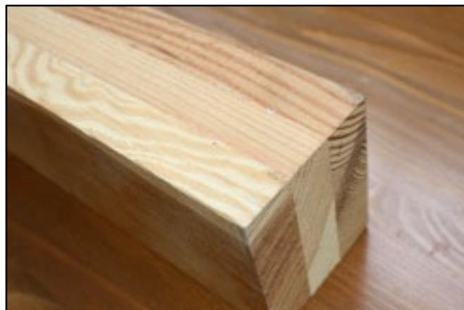
Figure 1.3.2: Carrelet trois plis en Pin
