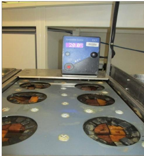
Figure 3.3.4 : Epreuves dans le bac d'eau
