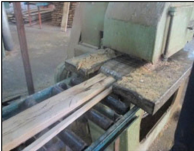
Figure 2.1.19: Délignage des lamelles.
