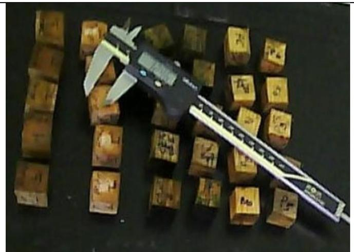
Figure 3.1.4 : Détermination du volume
