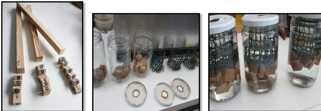
Figure 3.1.8 : Préparation des échantillons dans les récipients en verre.
