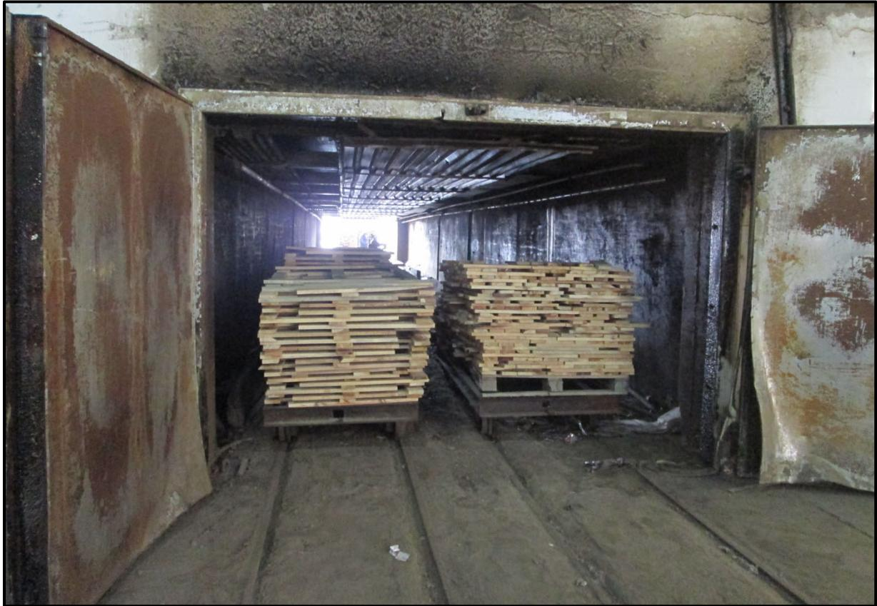
Figure 2.1.15 : Séchage des plateaux de bois.
