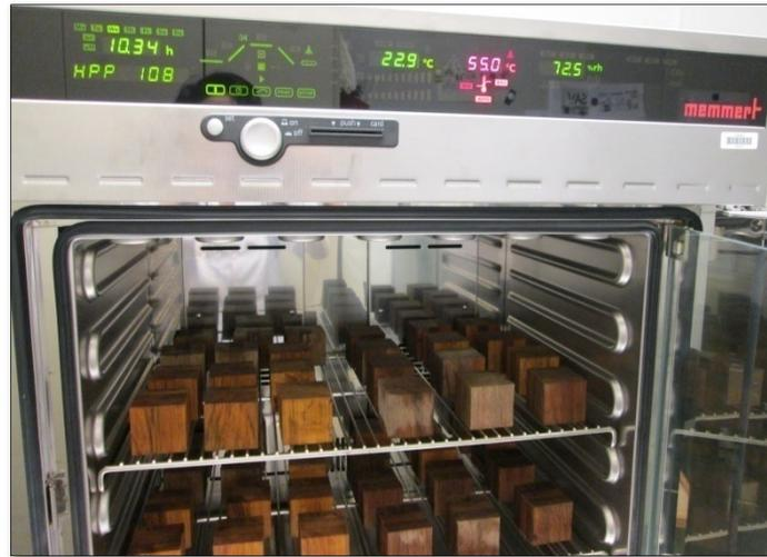
Figure 3.3.5 : Eprouvette dans l'étuve ventilée à la sortie de bain thermostaté
