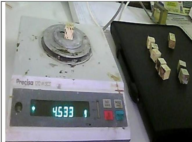
Figure 3.1.3 :Pesée des échantillons
