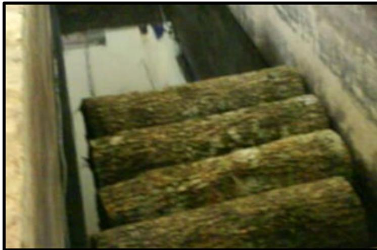
Figure 2.1.7 : Conditionnement des billons dans l'eau.
