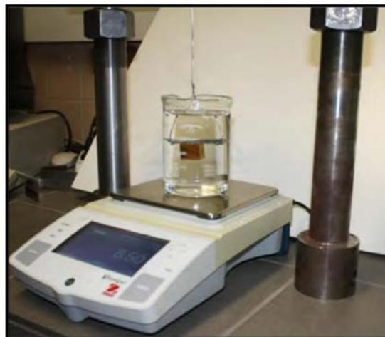
Figure 3.1.13 : Mesure du volume saturé d'une éprouvette utilisant le principe de la poussée d'Archimède (méthode de la double pesée).
