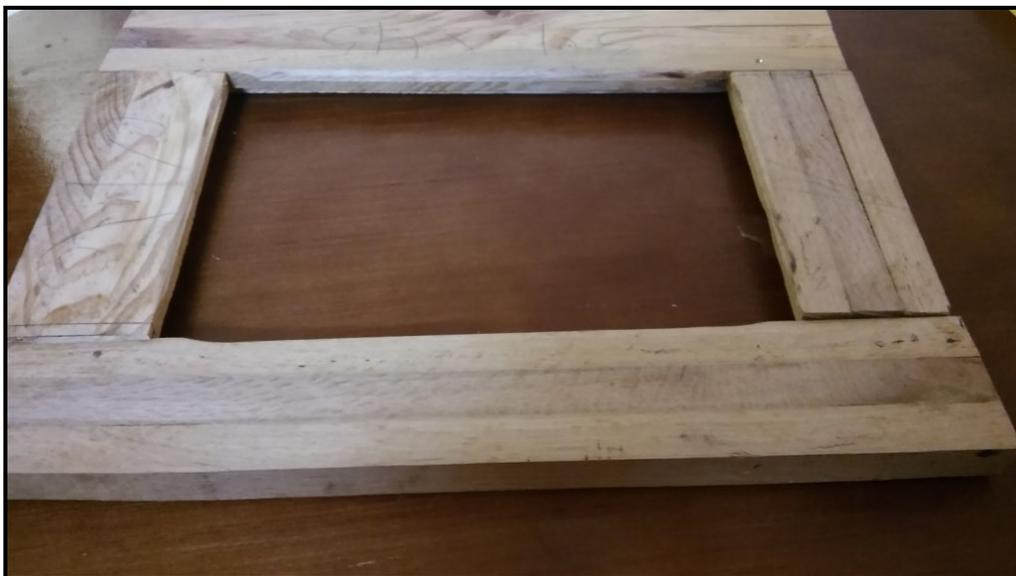
Figure 3.4.2 : Prototype de menuiserie fabriqué à partir de carrelets 3-plis mixte Pin d'Alep-Chêne afarès, constitué d'un volet et d'un battant
