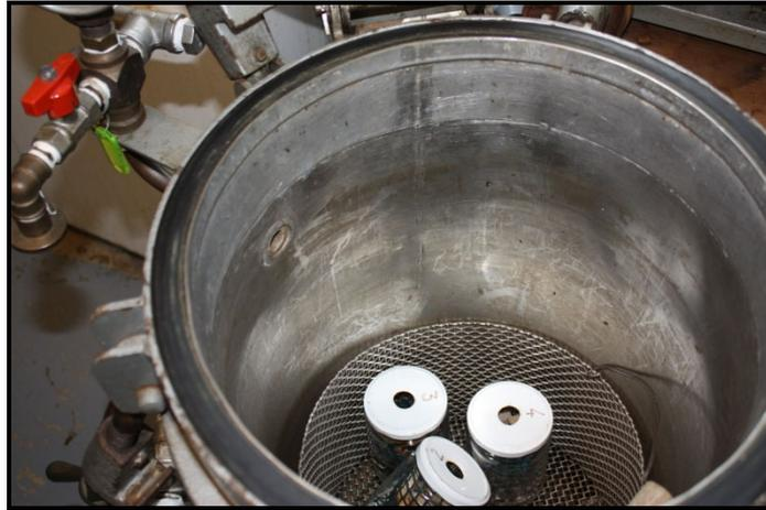
Figure 3.1.9 : Saturation des échantillons dans l'autoclave
