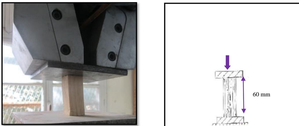
Figure 3.1.26 : Mise en place de l'essai de compression axiale (Photo DERBAL W.)
