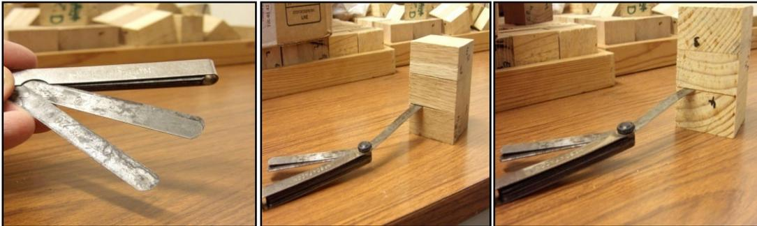
Figure 3.3.7: Méthode de mesure de l'ouverture des joints en utilisant la jauge d'épaisseur de 0,2mm
