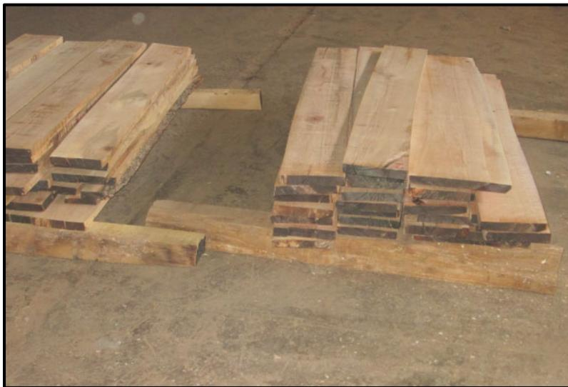
Figure 2.1.14 : Plateaux délicés en lamelles de 35 mm d'épaisseur
