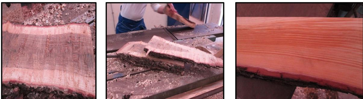
Figure 2.1.9 : Dégauchissage, rabotage et mise au format des bois débités (DERBAL W).
