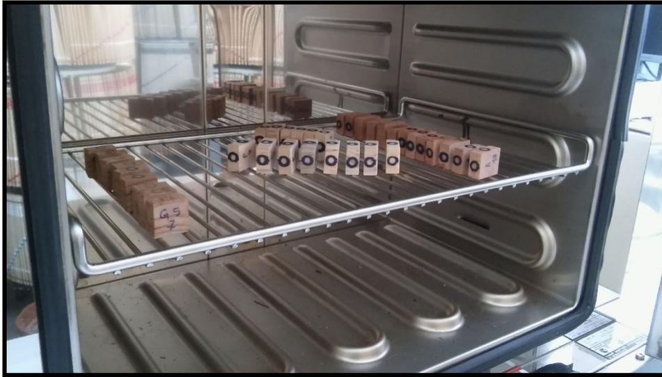
Figure 3.1.10 : Déshydratation des échantillons en étuve sèche.
