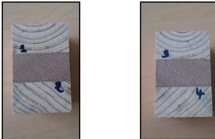
Figure 3.3.2 : Eprouvette avec numérotation des plans de colle.
