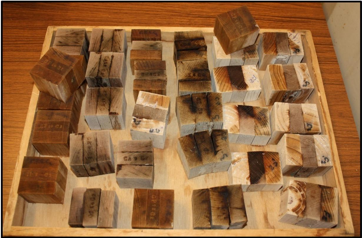
Figure 3.3.11 : Etat des éprouvettes à la fin d'essai
