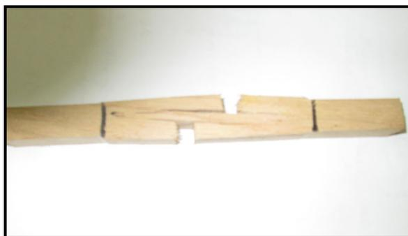
Figure 3.1.32 : Rupture d'éprouvette d'essai de cisaillement (chêne afarès).
