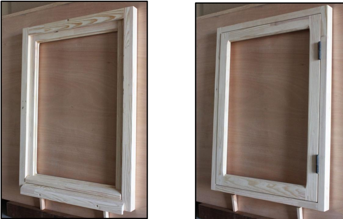
Figure 3.4.1 : Prototype de menuiserie fabriqué à partir de carrelets 3-plis en pin d'Alep, constitué d'un dormant et d'un battant(photos D. Guibal)
