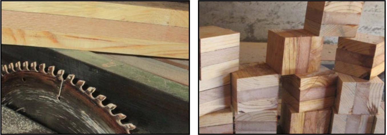
Figure 2.1.21 : Elaboration des éprouvettes prélevées dans les carrelets trois plis
