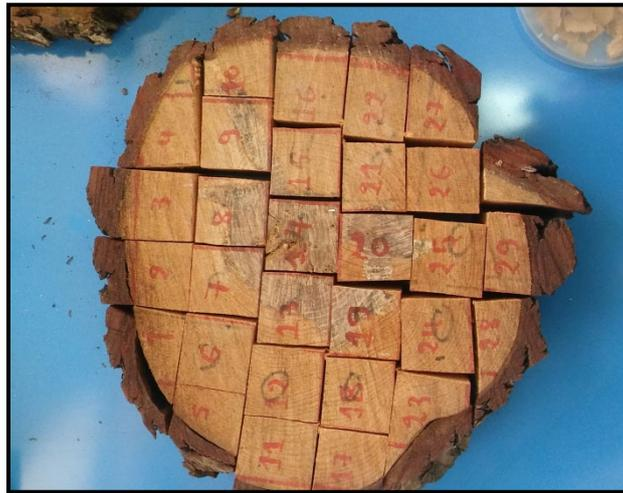
Figure 3.1.1 : Epreuve d'essai d'humidité
