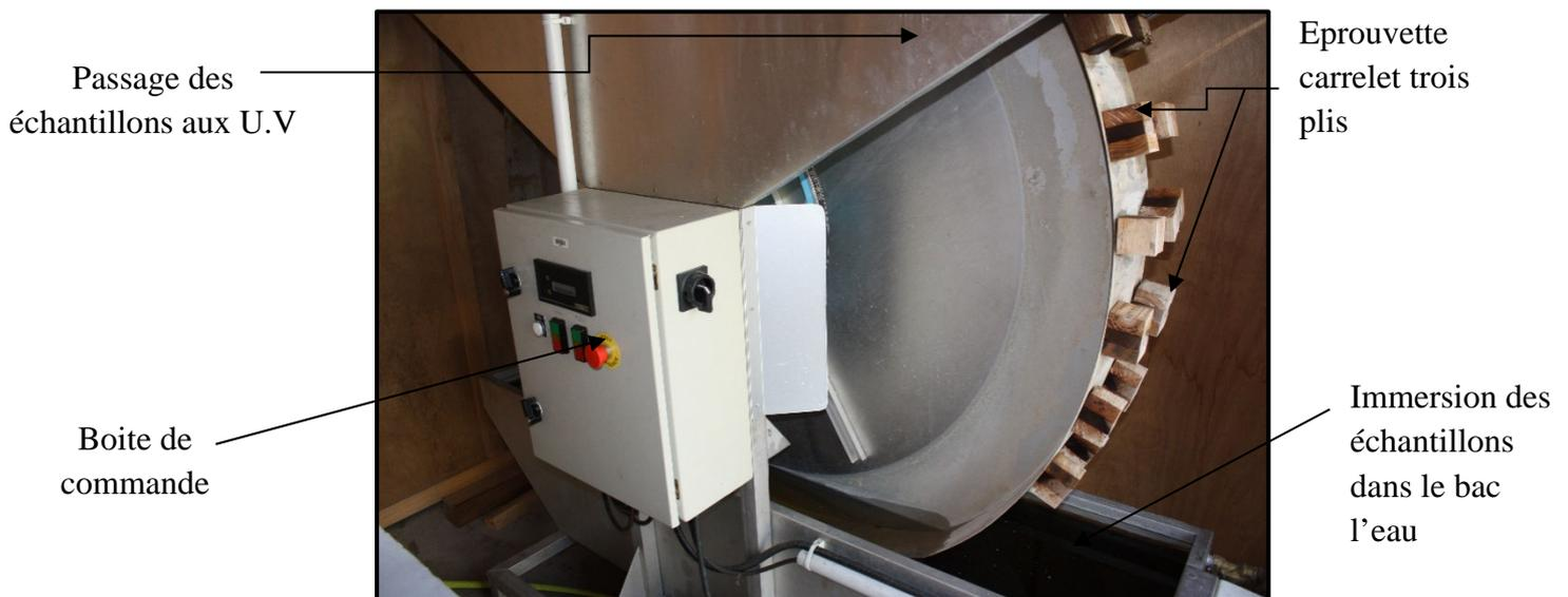
Figure 3.3.10 : Les différentes composantes ou phases de l'essai de vieillissement
