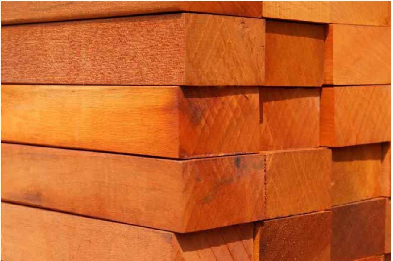
Traverses en Azobé (Photo Emmanuel Groutel, WALE, Gabon)
