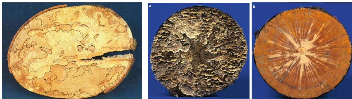
Figure 16 : Développement d'échauffure sur du hêtre, à gauche (23) ; échauffure sur épicéa : sporophore sur une coupe transversale (a) ; décoloration du bois quelques cm sous la surface (b) (24)
