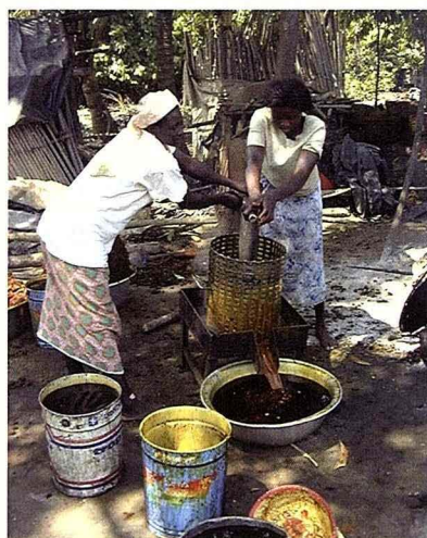
Extraction artisanale d'huile rouge avec une presse à vis verticale, Côte d'Ivoire.
