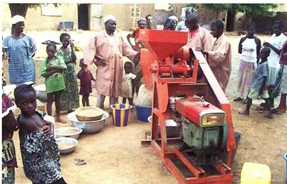
Essai du décortiqueur GMBF dans un village au Mali.
